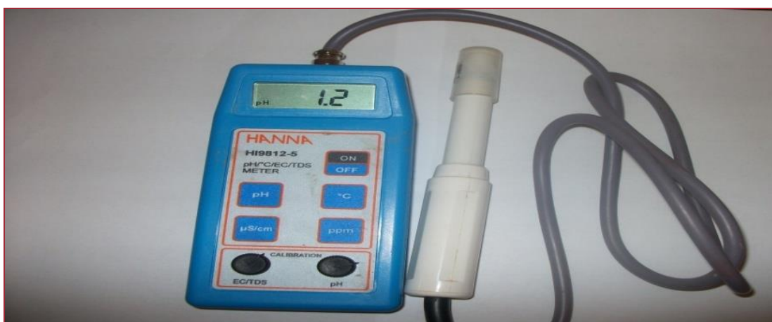
Fig. 4: représente la Multi-paramètres pour la détermination de : température, pH, et conductivité électrique
