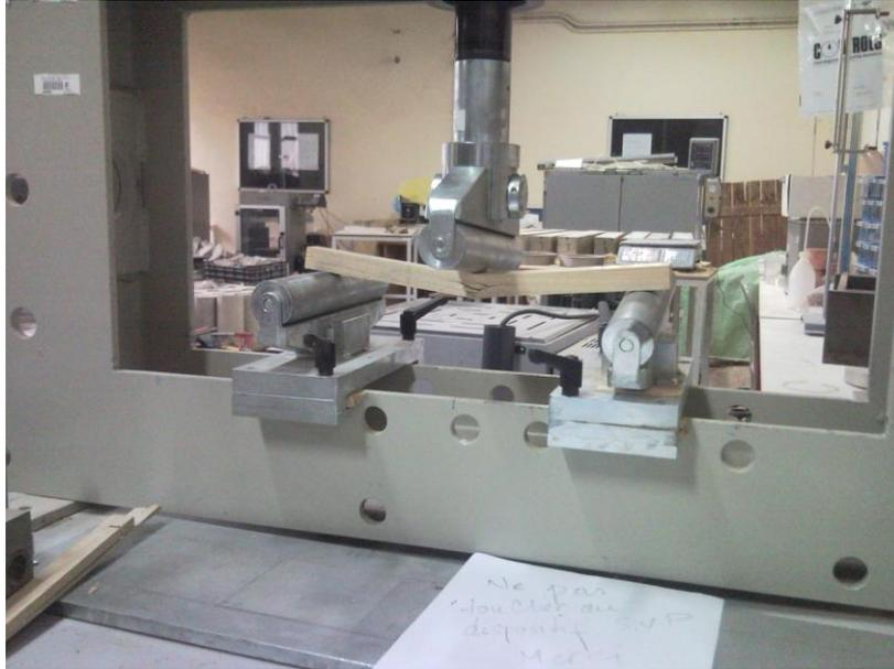
**Figure IV.13** – *Essai de résistance à la flexion.*
