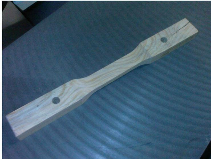
**Fig. IV.9** – *Eprouvette de traction parallèle aux fibres.*
