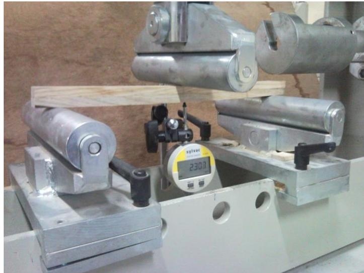
**Figure IV.12** – Essai de mesure du module de flexion.
