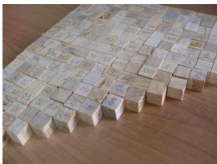
Figure IV.6 – Eprouvettes de mesure de la densité
