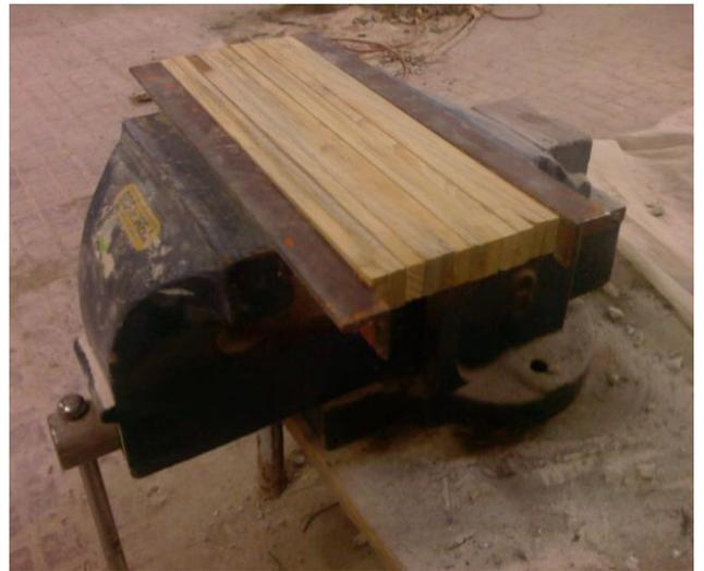
**Figure V.3** – Serrage des lamelles.
