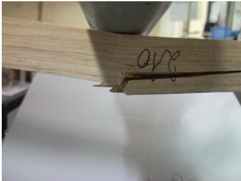
**Figure IV.14** – *Rupture d'éprouvette par essai de flexion.*
