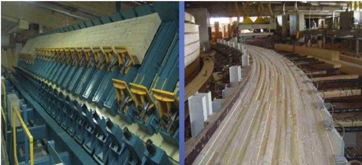
**Figure III.4** – *Serrage des lamelles*
