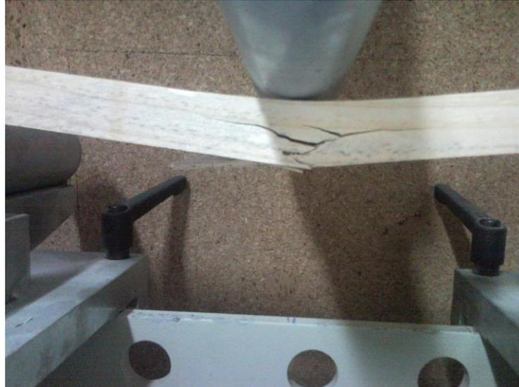
**Figure V.7** – Rupture d'une éprouvette en lamellé-collé par flexion.
