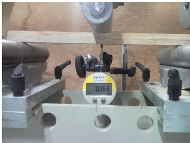
**Figure V.6** – Essai de mesure du module de flexion (lamellé-collé).
