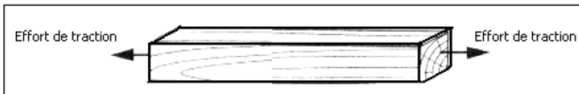
Figure II.9 Traction longitudinale
