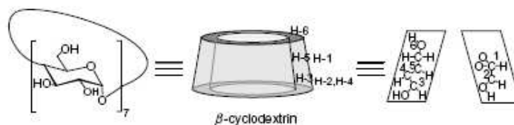
Figure 17 : Structure simplifiée montrant la forme tronconique.
