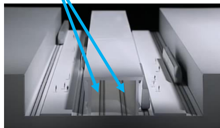
Fig78 : les 2 voies pour trains directes
