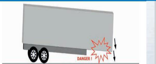
Fig112 : risques de basculement des remorques
