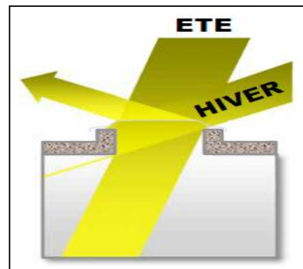
Figure 45: verrière horizontale (Source : EPFL-ENAC 2007)
