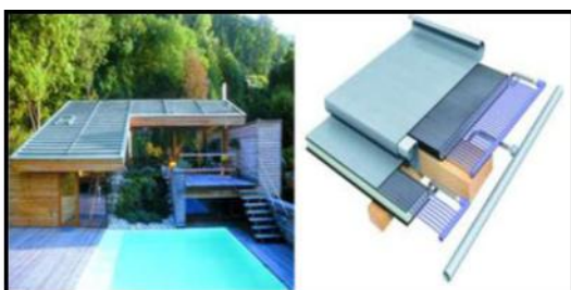
Figure 15 : Panneaux solaires thermiques non vitrés QUICK STEP® intégrés au bâtiment
