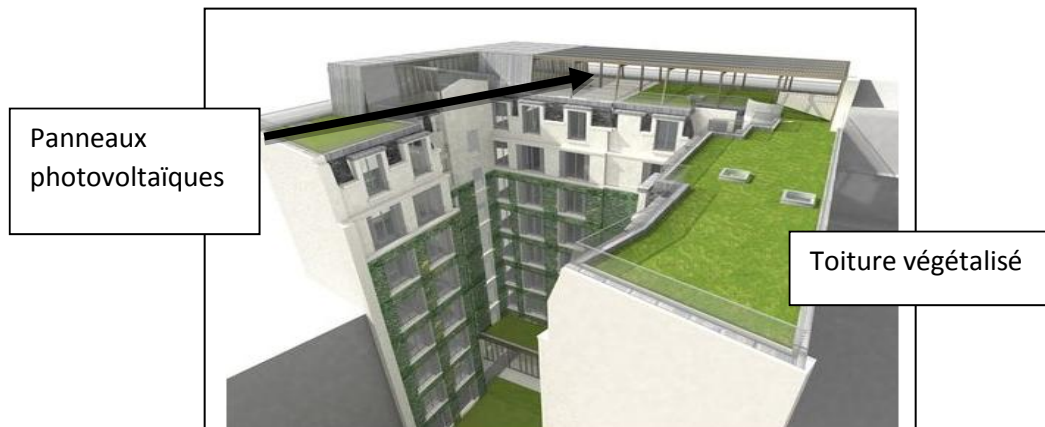
Figure 67 : 3D du projet illustrant le principe constructif
