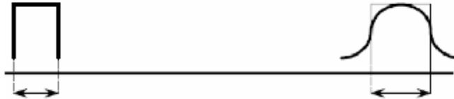
Figure 1.11 : Effet de la dispersion chromatique : le signal qui se propage s'élargit
