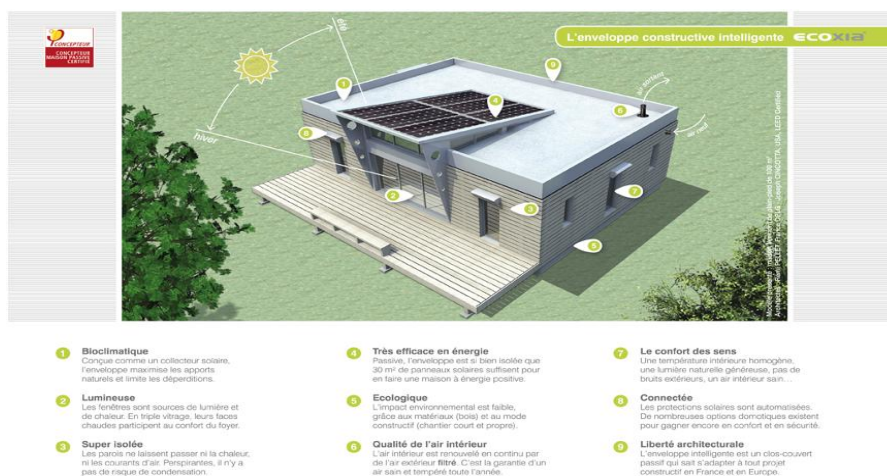
Figure 22 : Illustration d'une conception d'enveloppe intelligente (Source : www.ecoxia.com )
