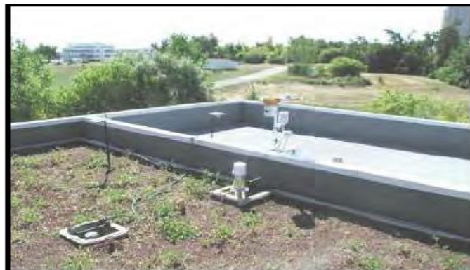
Figure 20 séparation de deux toit : le toit vert (à gauche) et le toit de référence (à droite)
