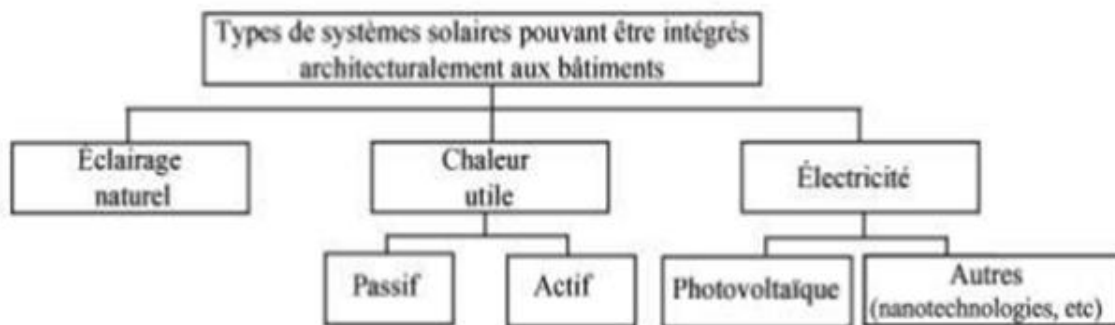
Figure 20: Types des systèmes solaires classés selon différents besoins pour le bâtiment.
