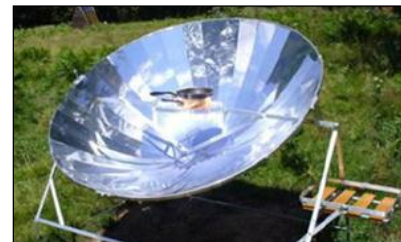
Figure 30: Le concentrateur parabolique. Source : GIZ/ Michael Netzhammer.
