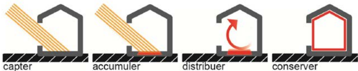
Figure 23: Représentation schématique des quatre principes du chauffage solaire passif.
