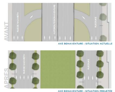
Fig 21: la nouvelle grille des rues
