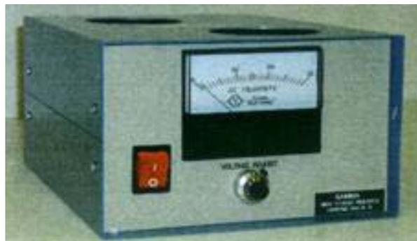
**Figure III.10:** Alimentation haute tension modèle ES20P-5 (+20 kV ; 5 W), IUT d'Angoulême de l'Institut PPRIME, Université de Poitiers.
