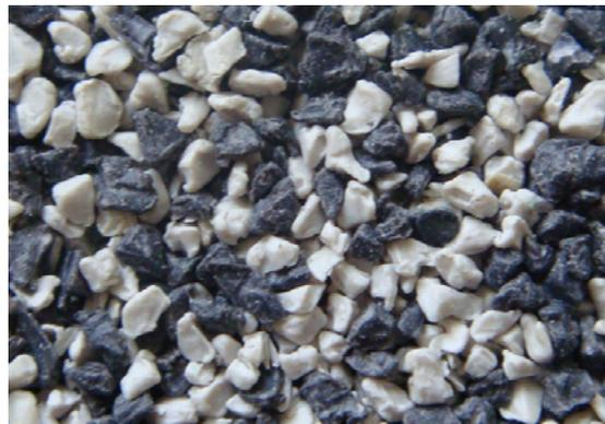
**Figure III.11:** Photographie des granules de l'ABS (blanche) et de HIPS (grise).
