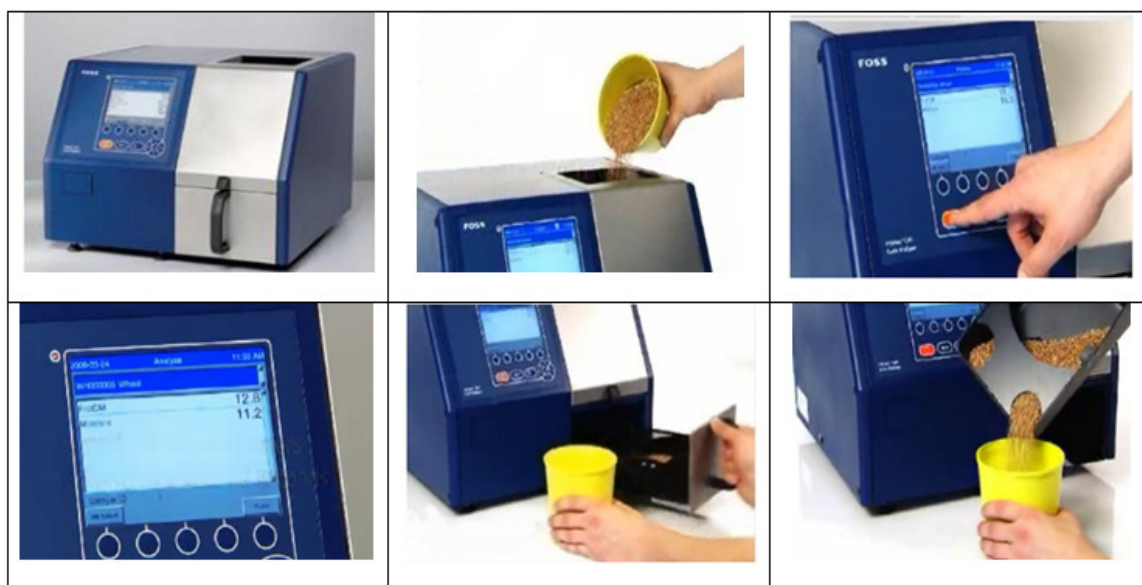
Figure 6 : Mode opératoire pour déterminer la teneur en eau avec l'Infratec 1241[4]
