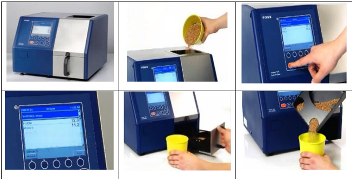
Figure 5 : Mode opératoire pour déterminer la teneur en protéine avec l'InfraTec 1241[4]
