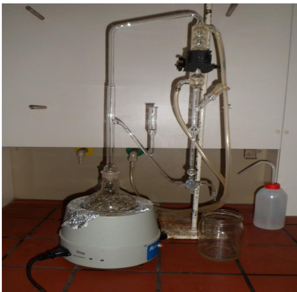
Figure 19: Montage d'hydrodistillation utilisé pour l'extraction de l'huile essentielle
