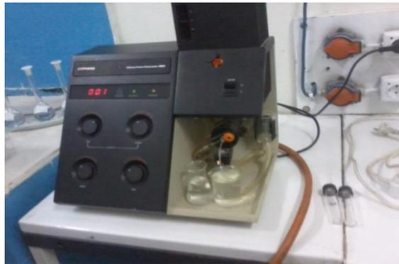
**Photo. n°5. Appareil de photométrie à flamme**
