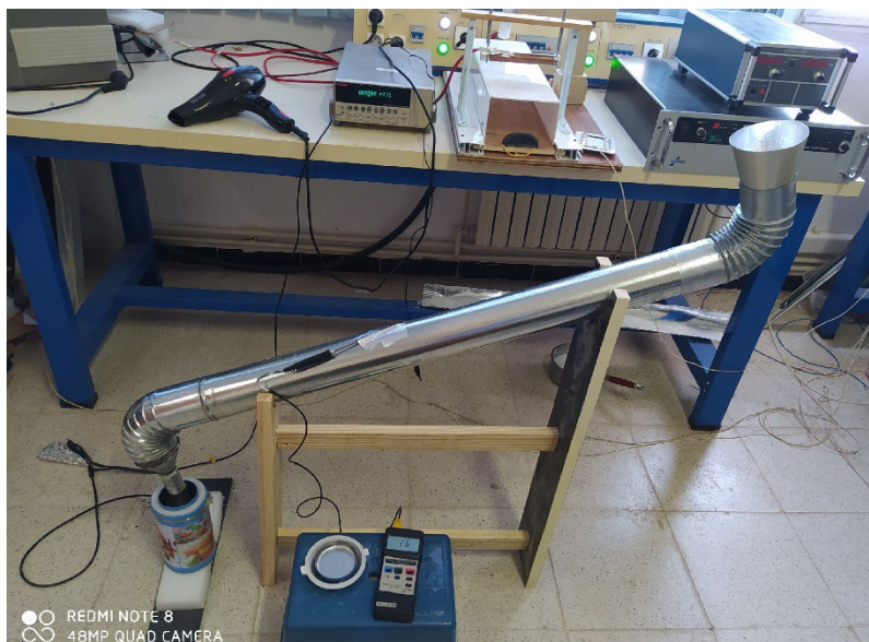
Figure II.6 : Photographie du dispositif de charge par effet triboélectrique utilisé lors des expériences.
