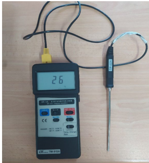
Figure II.13 : Thermomètre à deux canaux (interface informatique RS-232) modèle (TM-915A).
