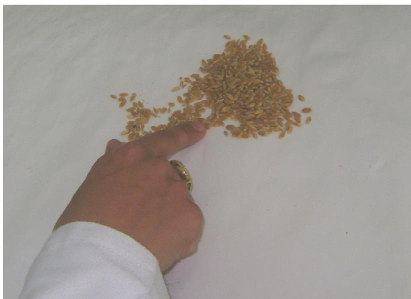
**Figure08** :Mode opératoire pour la détermination du poids de mille grains par le comptage manuel des grains
