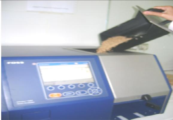
Placer le blé dur dans la cellule de la mesure de L'INFRATEC™1241
