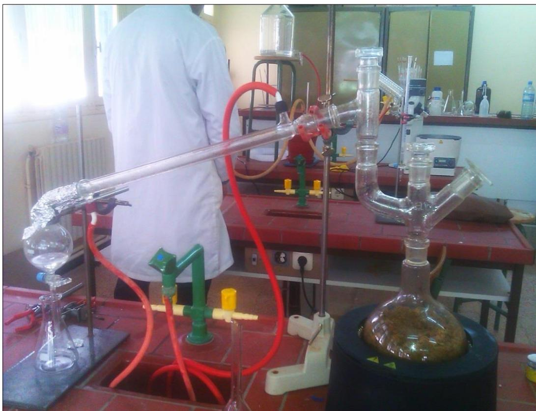
**Figure 12** : montage de l'hydrodistillation
