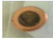
Figure IV.50 : Dépôt de l'alliage NiFe à partir de la solution :[BuMePyr][Tf 2 N]+Ni [TF 2 N] + [Fe(ClO 4 ) 2 ] [NTF 2 ]+Fe(ClO 4 ) 2 ].
