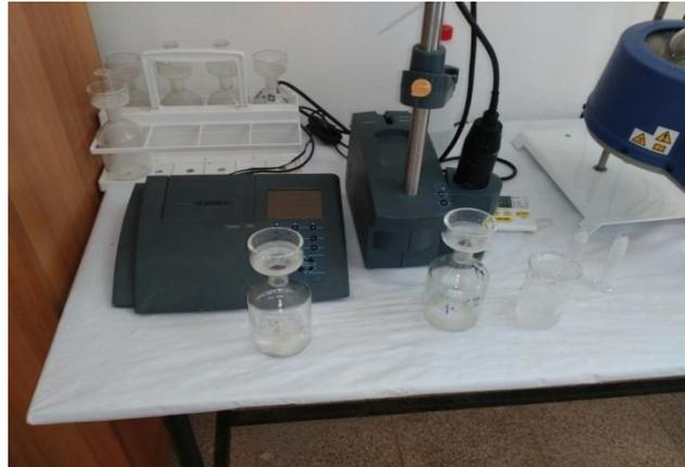
**Figure 19 :** Appareil de l'analyse de DBO.
