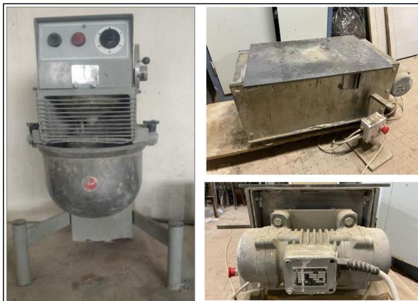
**Figure II-7.** (a) Malaxeur utilisé, (b) Table vibrante utilisée pour la confection des mortiers.
