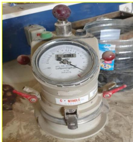
Figure II-11. Dispositif de mesure de l'air occlus.
