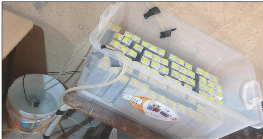
**Figure II-18** Image du test d'absorption capillaire.
