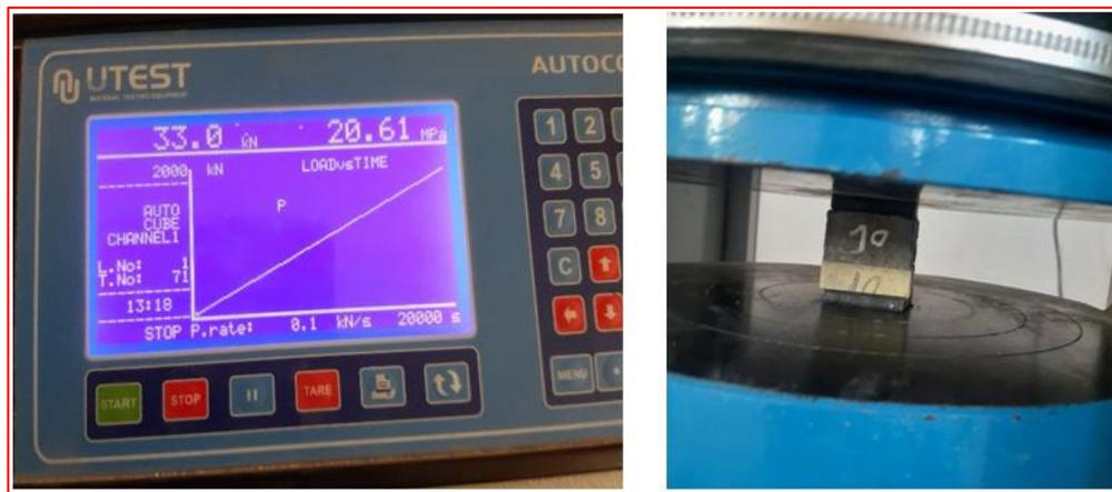
**Figure II-16.** La presse électromécanique du test de compression.
