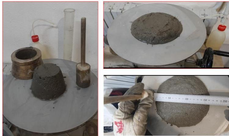
**Figure II.9.** Mesure d'étalement à table de choc.
