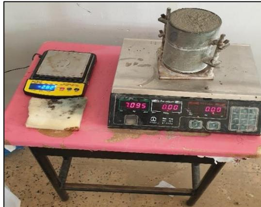
Figure II-10. Mesure de la masse volumique de bio-mortier.
