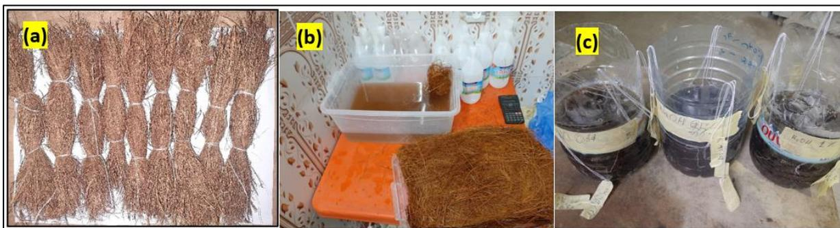
**Figure II.3.** (a) Faisceau de fibres, (b) Fibres lavées à l'eau distillée, (c) Fibres traitées au NaOH.
