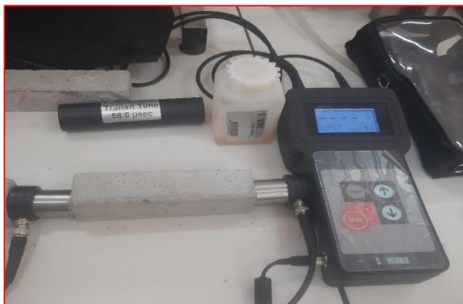
**Figure II-17.** Appareil de mesure de propagation des ondes ultrasoniques.
