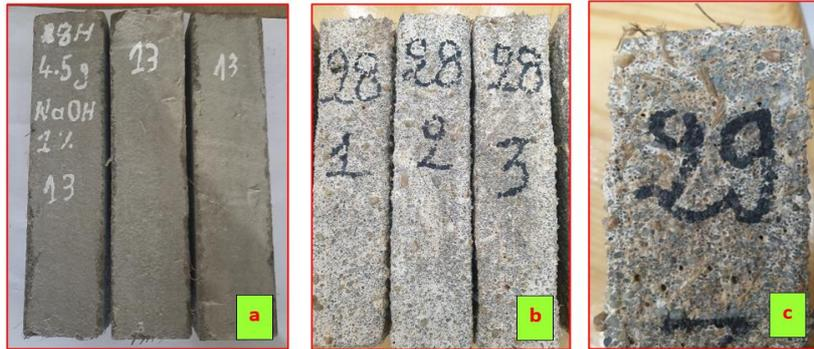
**Figure II. 20** Étapes de dégradation des mortiers par  $H_2SO_4$  : (a) état initial, (b) état après 90 jours et (c) état final après 175 jours.
