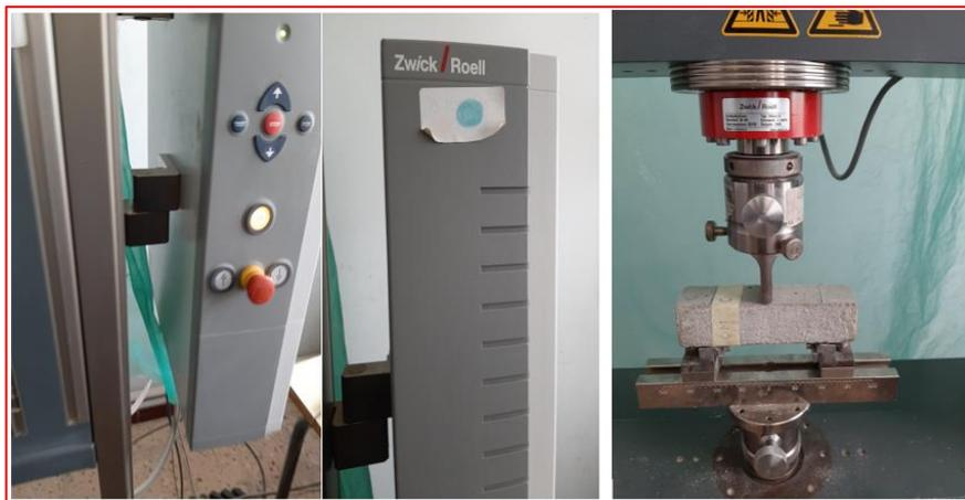
**Figure II-14.** La presse électromécanique du test de flexion.
