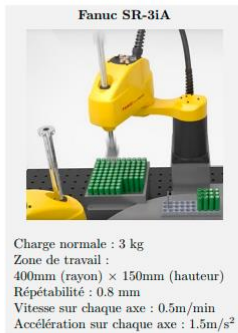
Figure 3.3 : Caractéristiques principales d'un robot SCARA (Fanuc) [20]
