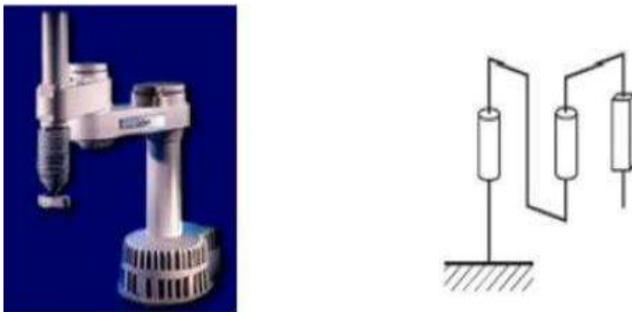
Figure 1.24 : Structure d'un robot SCARA [1]
