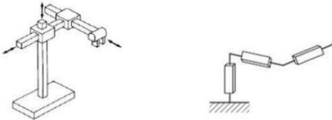
Figure 1.20 : Structure d'un robot cartésien [1]
