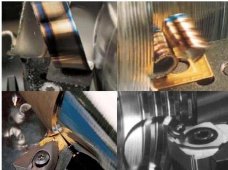
**Figure.I.1.** Photographie de différentes opérations en tournage industrielles.
