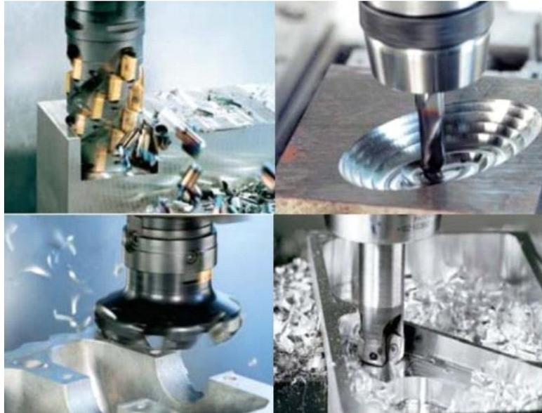
**Figure.I.2.** Photographie de différentes opérations en fraisage industrielles.
