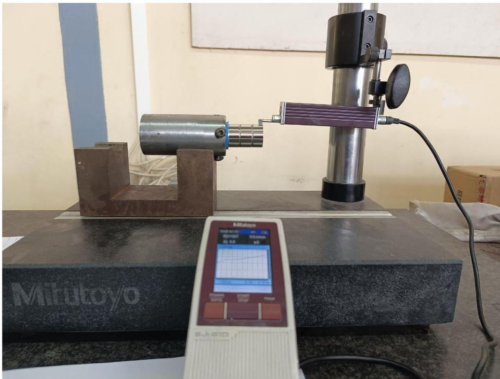
**Figure I.4.** Rugosimètre SurfTest Sj201.
