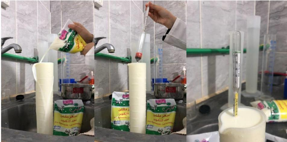
**Photographie III.4 : Mesure de la densité et la température par lacto-thermo-densimètre.**
