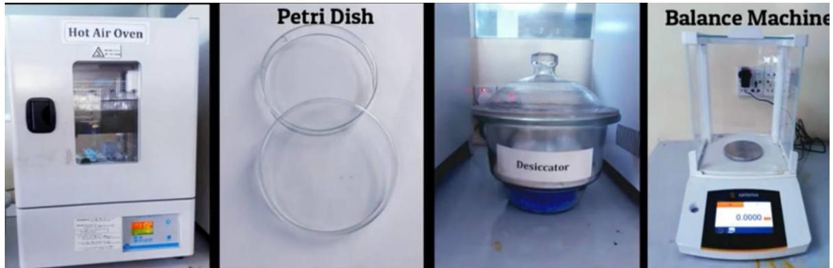
*Photographie III.11 : Instrument de mesure de la matière sèche totale (EST).*
