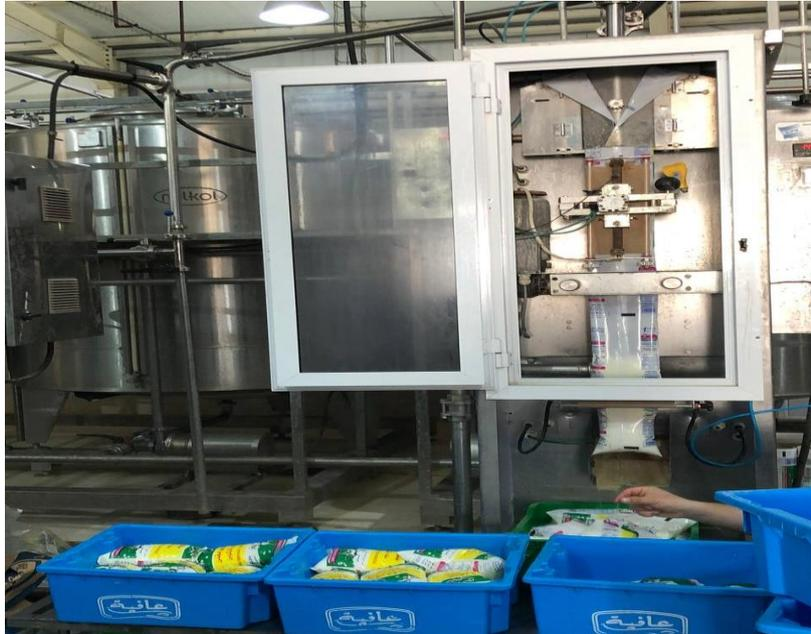
*Photographie II.7 : La machine de Conditionnement.*
