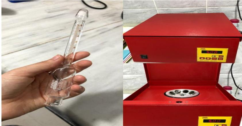
*Photographie III.8 : Butyromètre de GERBER .*
