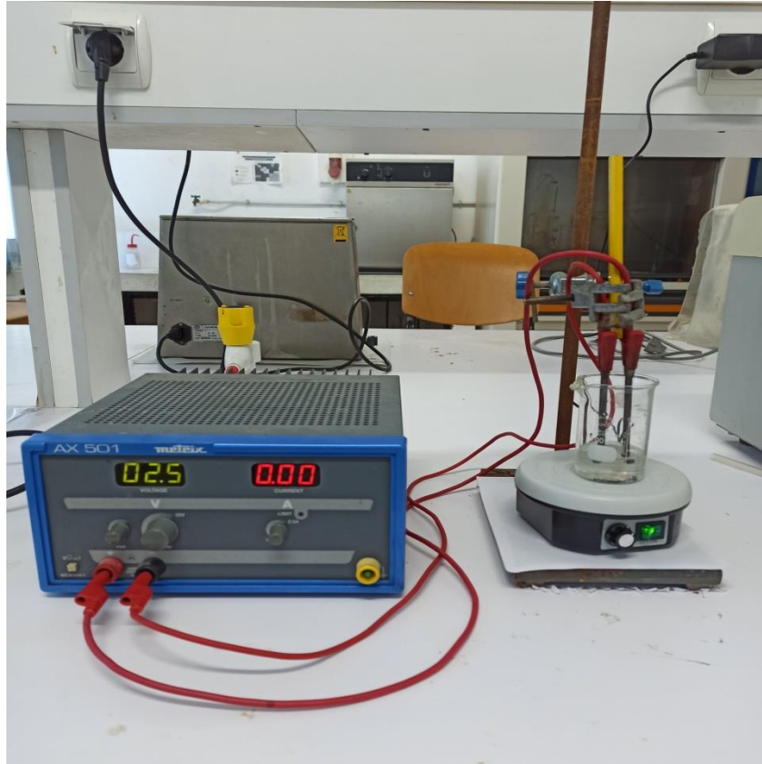
Figure III.2 : Le dispositif expérimental utilisé pour l'élimination des métaux lourds
