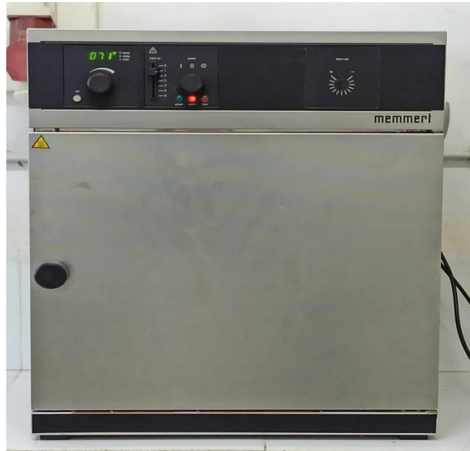
Figure III.4 : Étuve U de Memmert utilisée lors de ce travail
