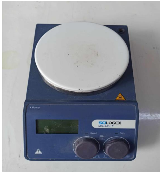
Figure III.3 : Agitateur magnétique à plaque chauffante MS-H-Pro Plus (SCIOGEX, USA) utilisé dans ce travail
