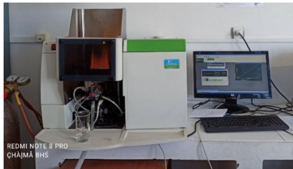
Figure VI.15 : Spectroscopie d'absorption atomique de la marque Perkin Elmer AA400
