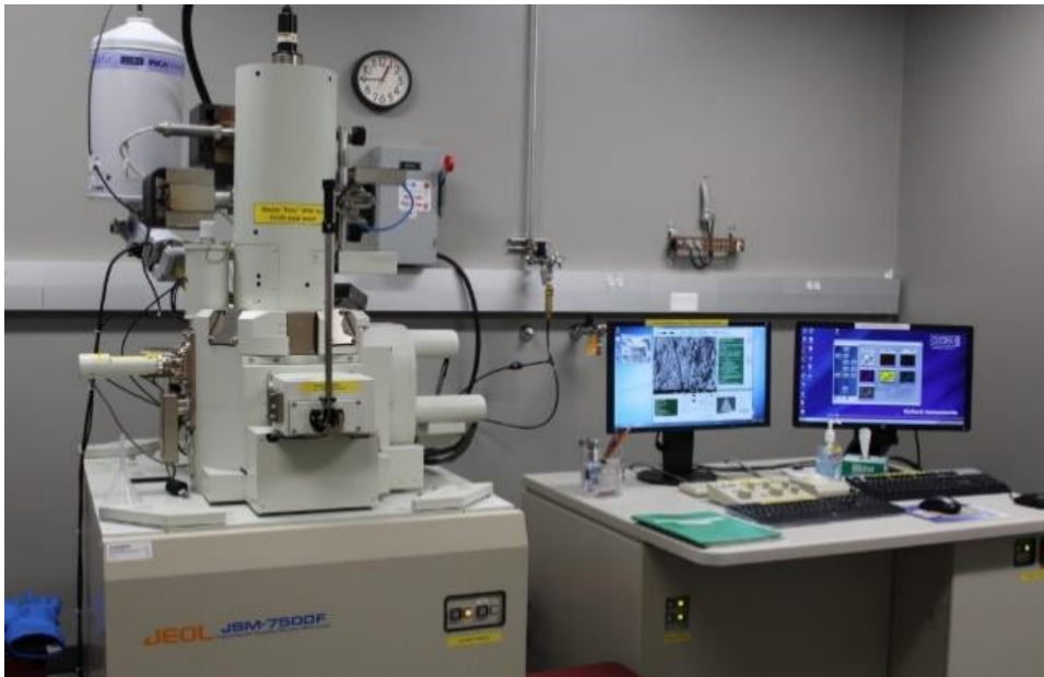
Figure III.10 : Microscope électronique à balayage JEOL. JSM – 7500F
