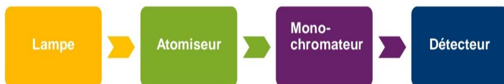
Figure II.14 : Installation générale de la spectroscopie d'absorption atomique [99]
