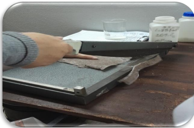
Figure III.7: Le découpage des plaques avec une découpeuse manuelle.
