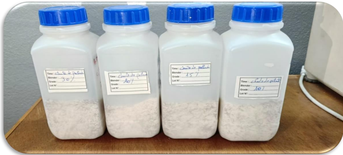
Figure III.5: Les quatre mélanges (PEHD +fibres de washingtonia).
