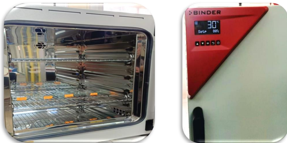
Figure III.18: Les échantillons dans une étuve à 80 °C.
