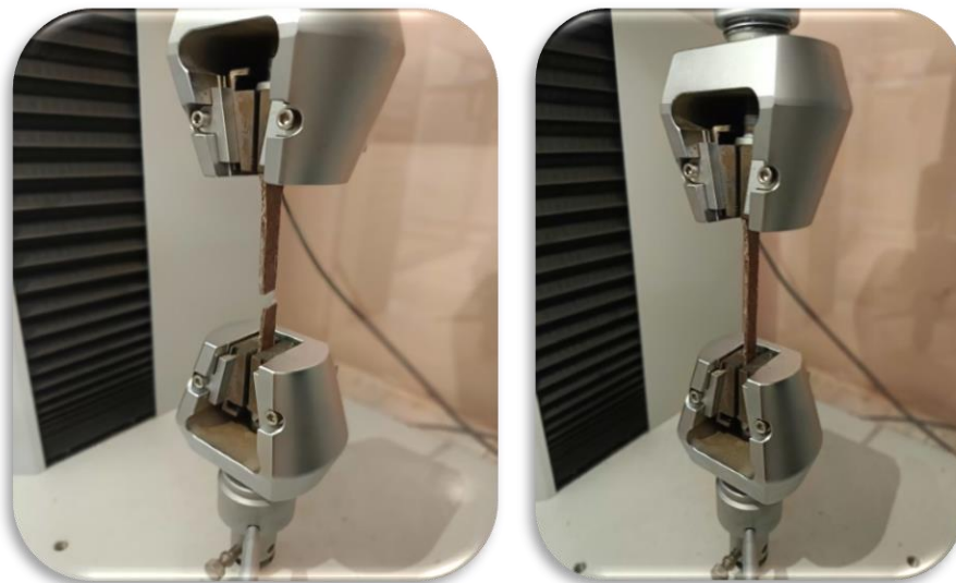
Figure III.22: Représente les mâchoires utilisées au cours de l'essai de traction
