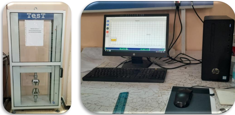
Figure III.21: Machine de traction type Test Kallibrierlabor modèle 918239 et leur logiciel.
