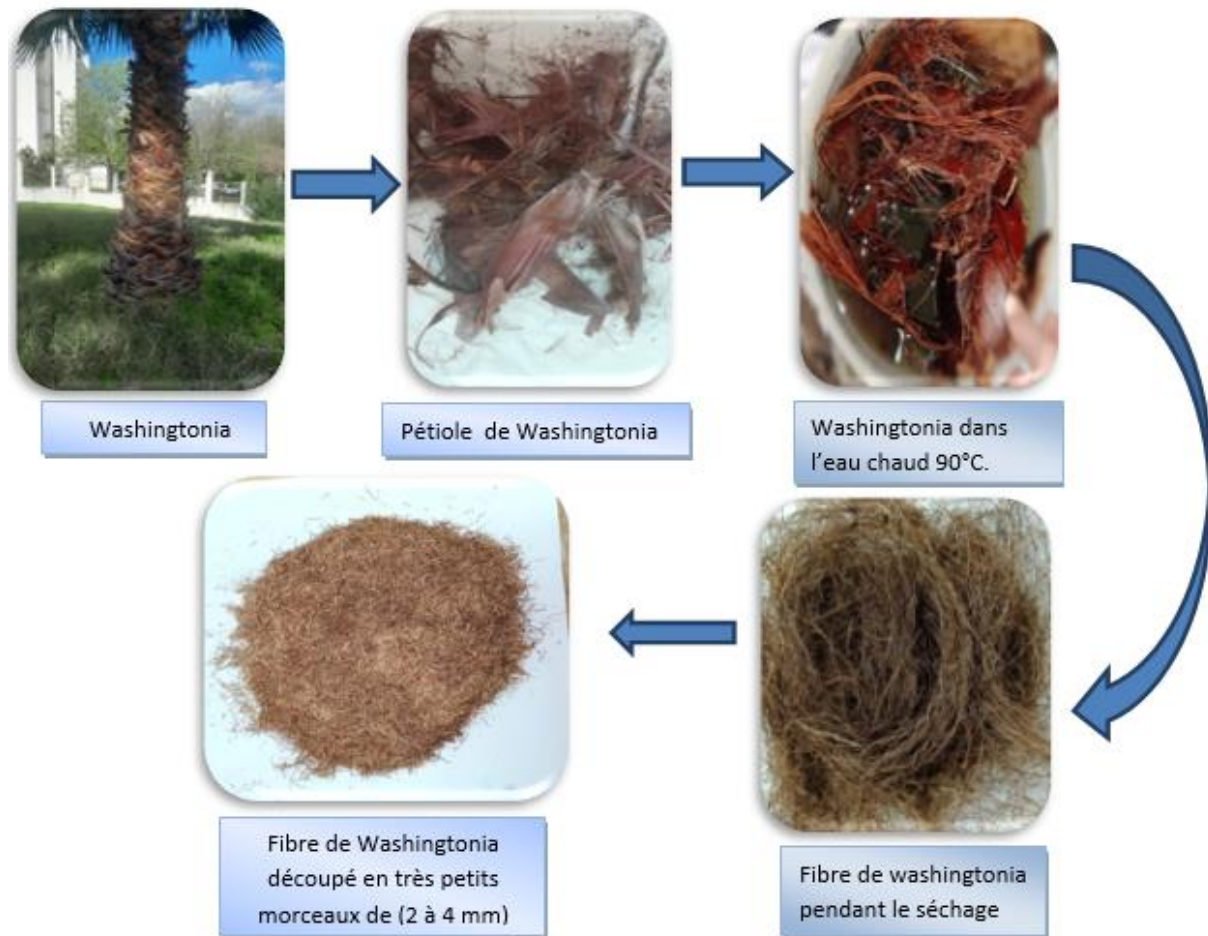
Figure III.4: Les étapes de préparation des fibres de washingtonia.
