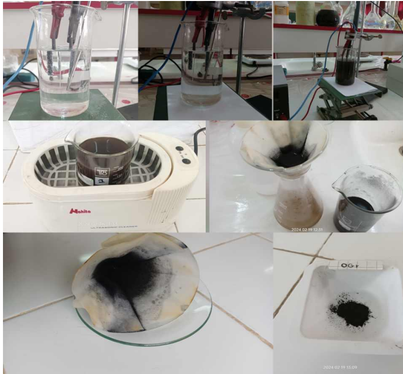
Figure IV. 2:Etapes de synthèse électrochimique de l'oxyde de graphène réduit (OGr).
