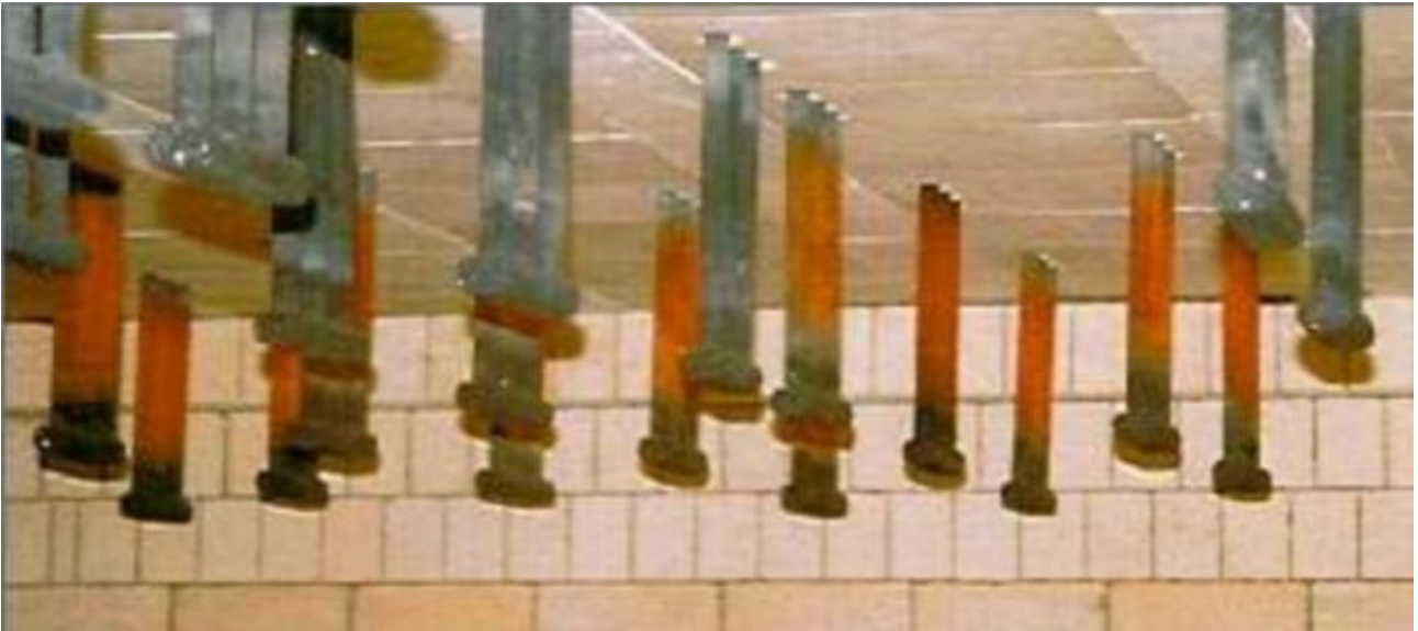
Figure II.14: Photo représentant les éléments chauffants au sein du bain d'étain.
