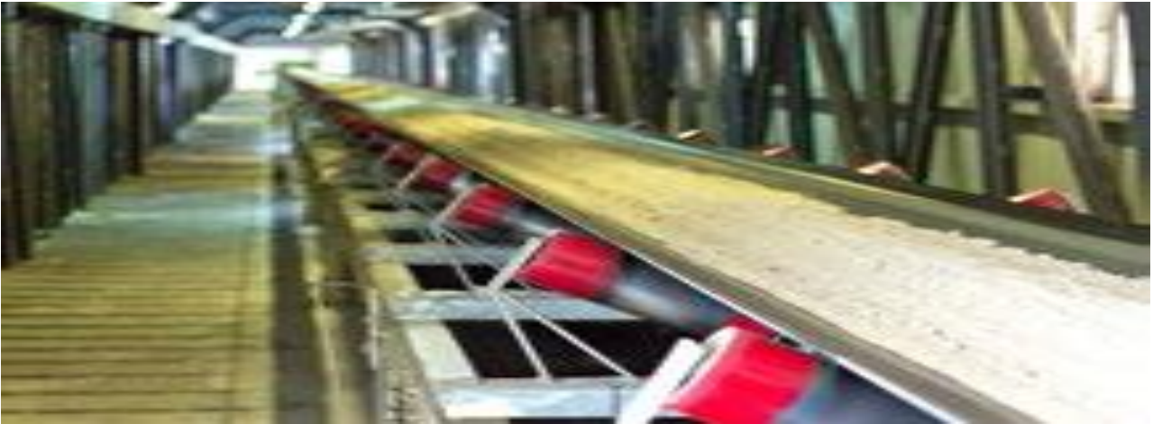
Figure II.3: Le mélange transporté vers le four.
