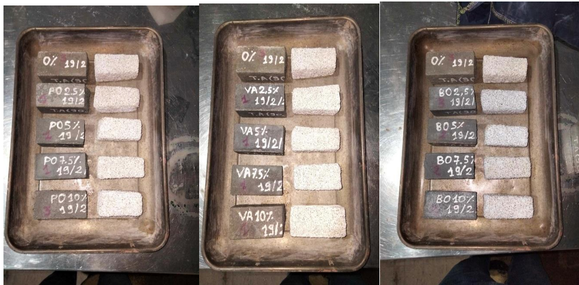
Figure III.17 : Dégradation des différents mortiers élaborés
