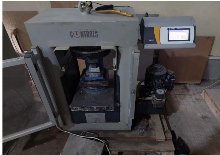
Figure II.30 : Machine et dispositif de mesure de la résistance à la compression
