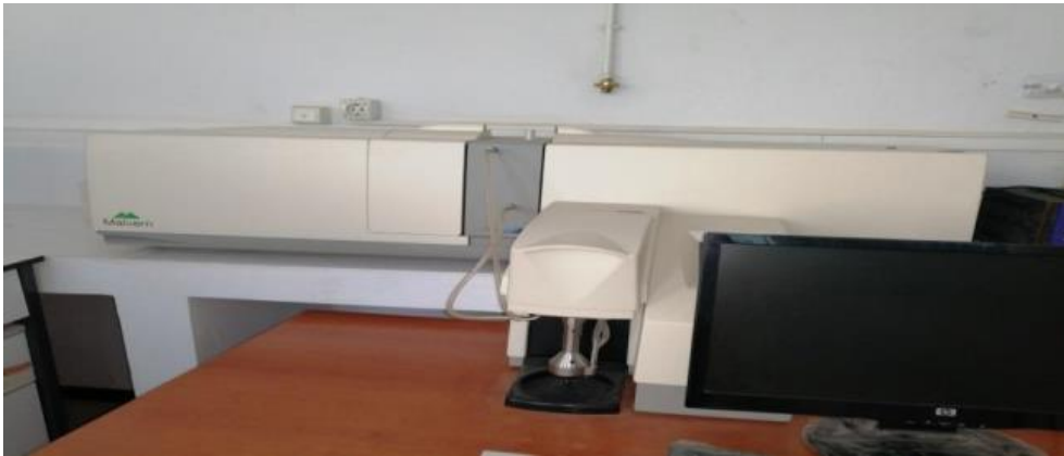
Figure II.13 : Appareil d'analyse granulométrique : Mastersizer 2000 Malvern
