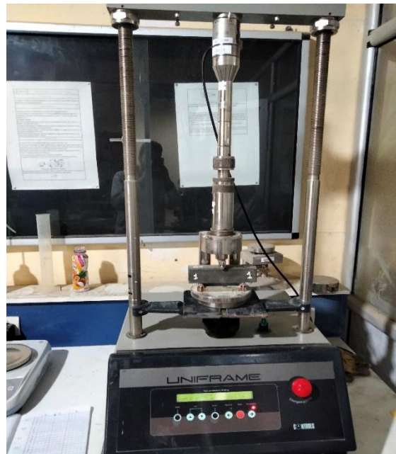
Figure II.29 : Machine et dispositif de l'essai de la traction par flexion
