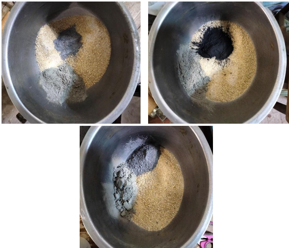
Figure III.20 : Les étapes de préparation de la pâte des nouveaux mortiers
