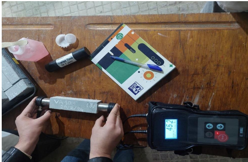
Figure II.28 : Essai de mesure directe du temps de propagation d’onde par Ultrasons
