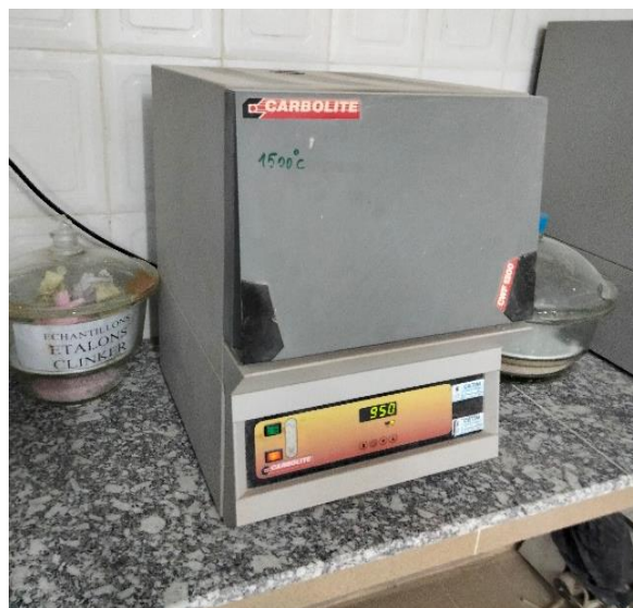
Figure II.18 : Four de calcination pour PAF
