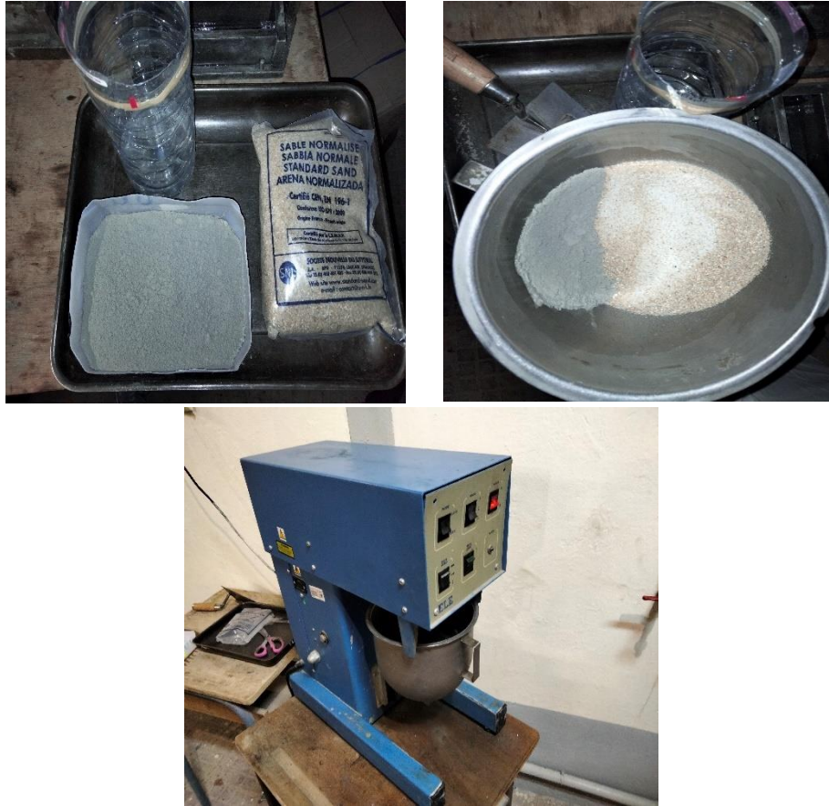
Figure II.19 : Les étapes de préparation de la pâte du mortier normalisé
