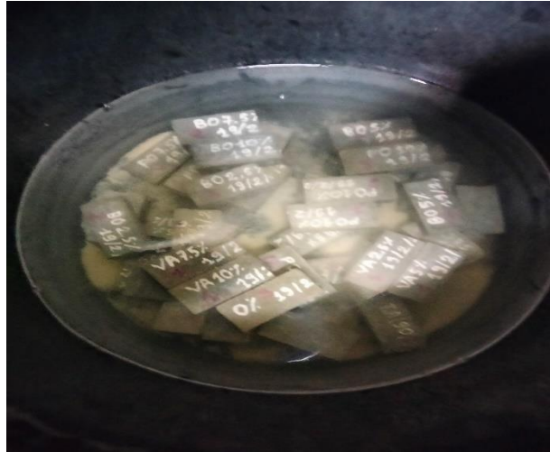
Figure II.32 : Epreuves soumises à l'acide sulfurique H_2SO_4 (5%)
