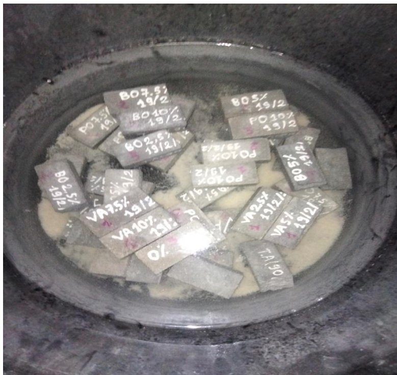
Figure II.25 : Cure des éprouvettes à l'eau pendant (2, 7, 28 et 56) jours
