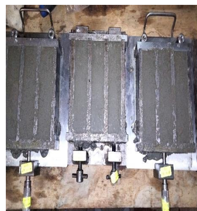
Figure II.23 : Dernière vibration et rasage
