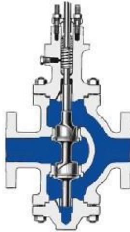
**Figure (4.11)** : Vanne à clapet double [12].
