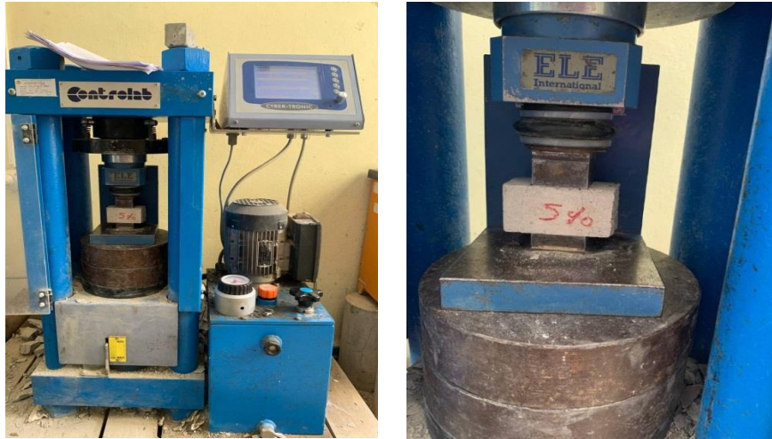
Figure III.20: Essai de compression réalisé sur les éprouvettes (4 x 4 x 16) cm 3
