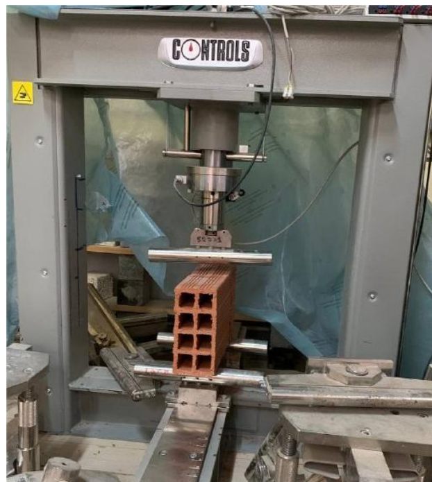
Figure III.18 : Essai de la résistance à la traction par flexion de brique
