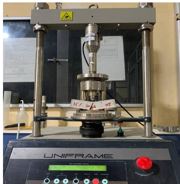
Figure III.19 : L'essai de flexion à l'état durci.
