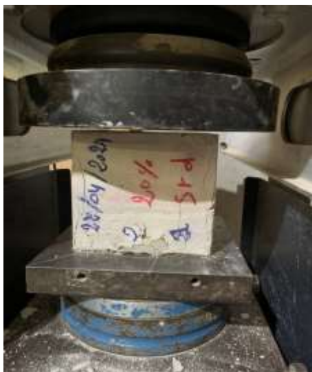
Figure IV.1 : Mode de rupture des éprouvettes par la presse.
