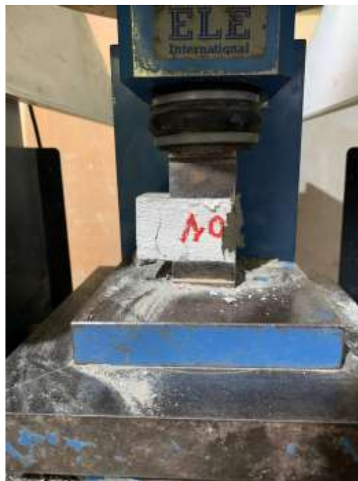
Figure IV.5 : Mode de rupture des éprouvettes de mortier par la presse.
