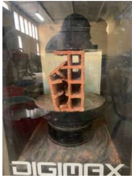
Figure IV.3 : Mode de rupture de la brique par la presse.
