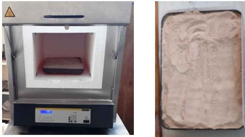
Figure III.8. Calcination thermique du kaolin (Metakaolin). [1]
