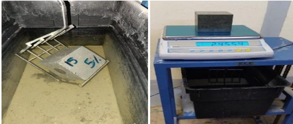
Figure IV.8. Mesure de la Porosité accessible à l'eau
