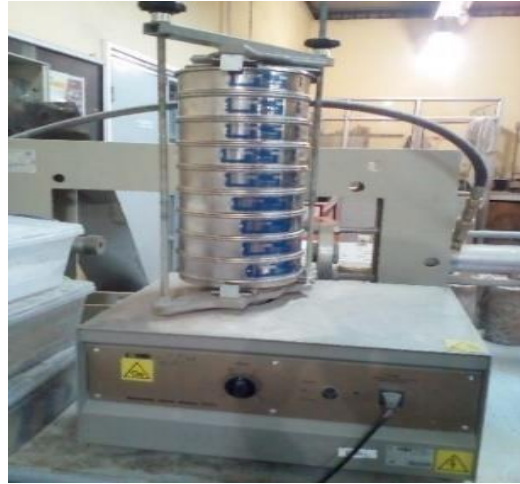
Figure III.1. Essai de granulométrie par tamisage. [1]
