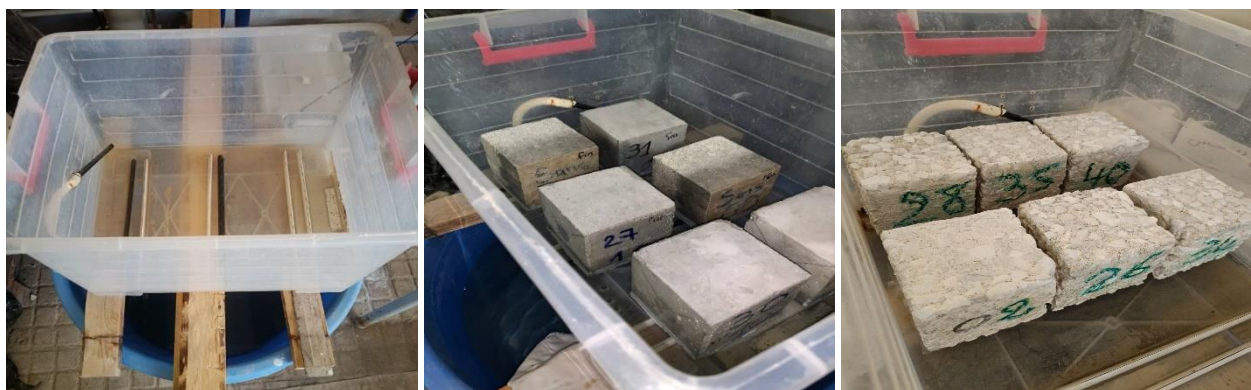
Figure IV.11. Essai d'absorption d'eau par capillarité avant et après exposition à l'acide.
