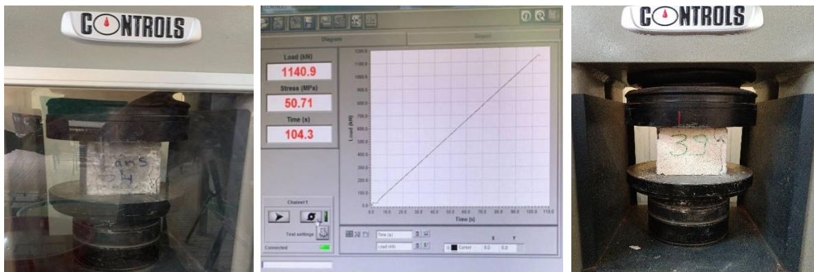
Figure IV.5. Mesure de la résistance à la compression avant et après les attaques d'acide.
