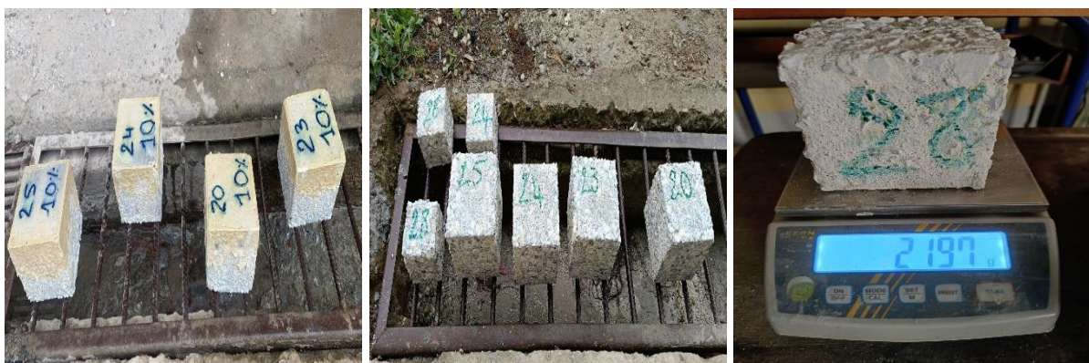
Figure IV.4. L'état des éprouvettes après l'attaque sulfurique
