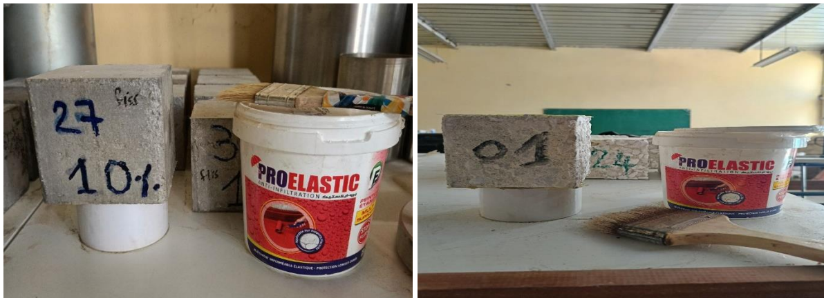
Figure IV. 10. Imperméabilisation des éprouvettes avant et après exposition à l'acide.
