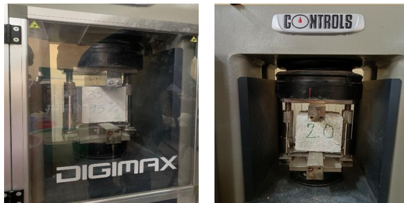
Figure IV.7. Mesure de la résistance à la traction par fendage avant et après les attaques d'acide.
