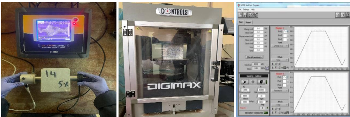
Figure IV.2 Protocole de pré-fissuration et mesure de la vitesse de l'onde ultrasonique
