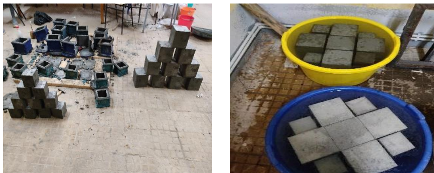
Figure III.15. Démoulage et conservation des éprouvettes de béton. [1]
