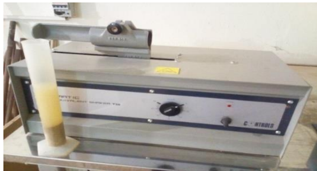
Figure III.3. Appareillage de l'essai équivalent de sable. [1]
