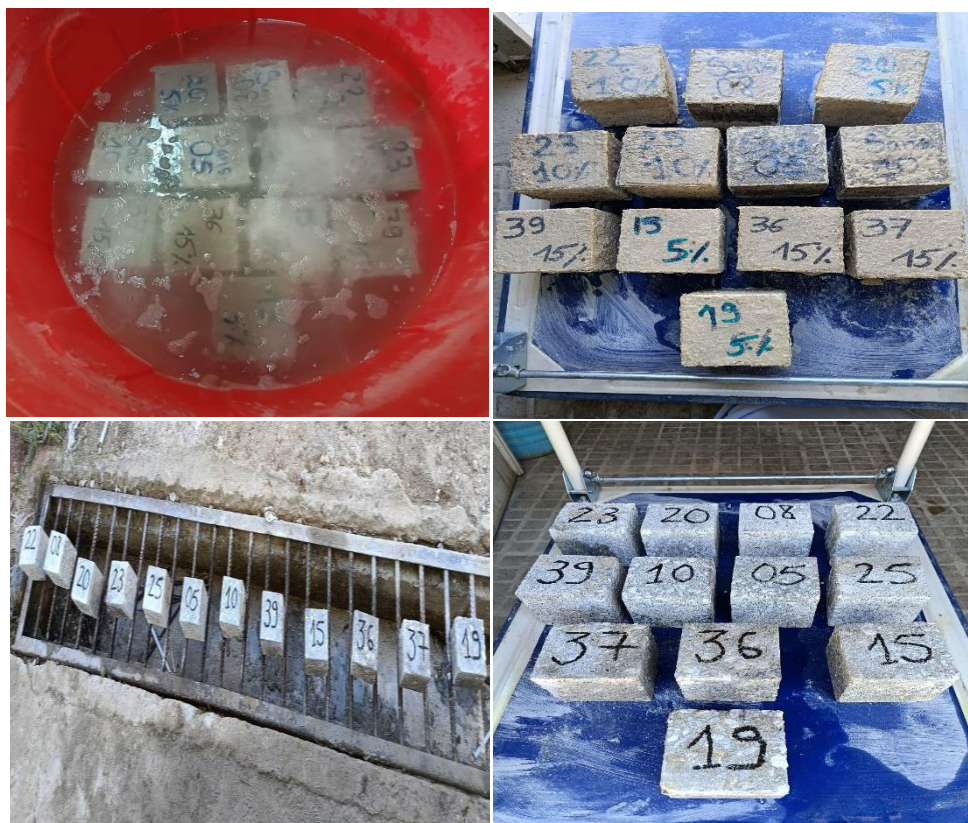
Figure IV.9. L'état des éprouvettes après fissuration et exposés à l'acide sulfurique.
