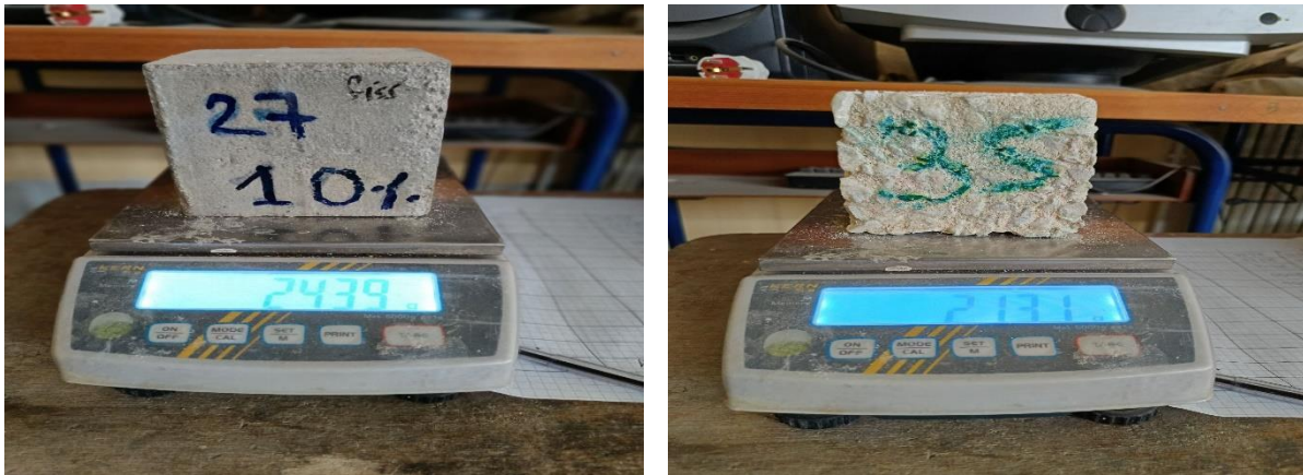
Figure IV.12. Mesure du poids des éprouvettes avant et après exposition à l'acide.
