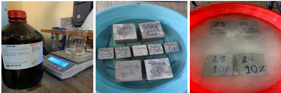
Figure IV. 3. Essai d'attaque à l'acide sulfurique
