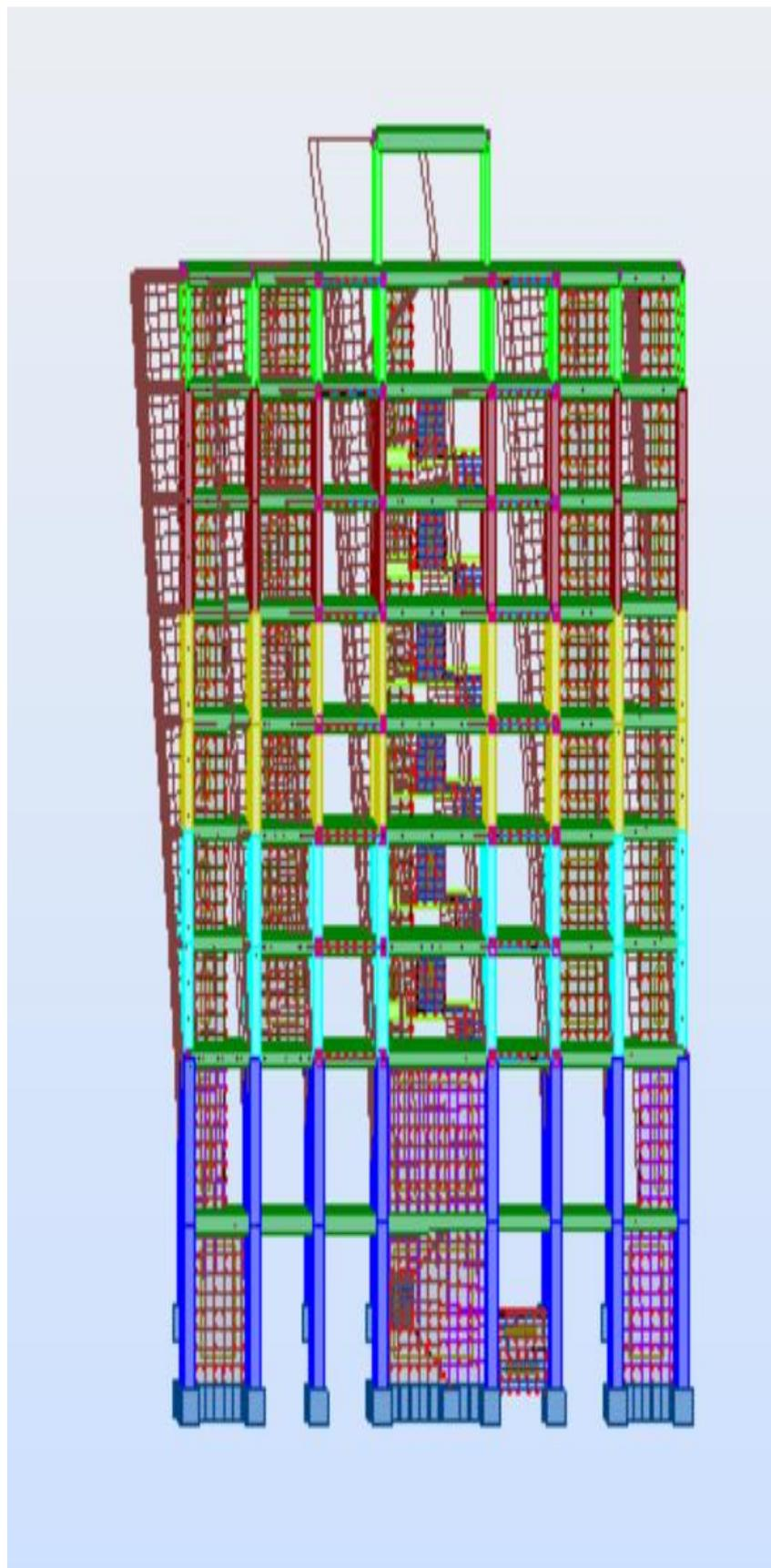
**Figure IV- 6:** 1<sup>er</sup> mode de déformation de la structure à cause des efforts sismiques vue : X-Z
