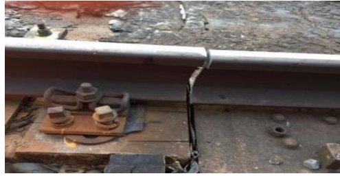
Figure VI. 10: .cas d'un rail rompu [21]
