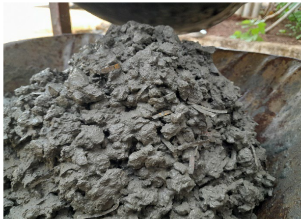
Figure II.11. Béton de fibres.
