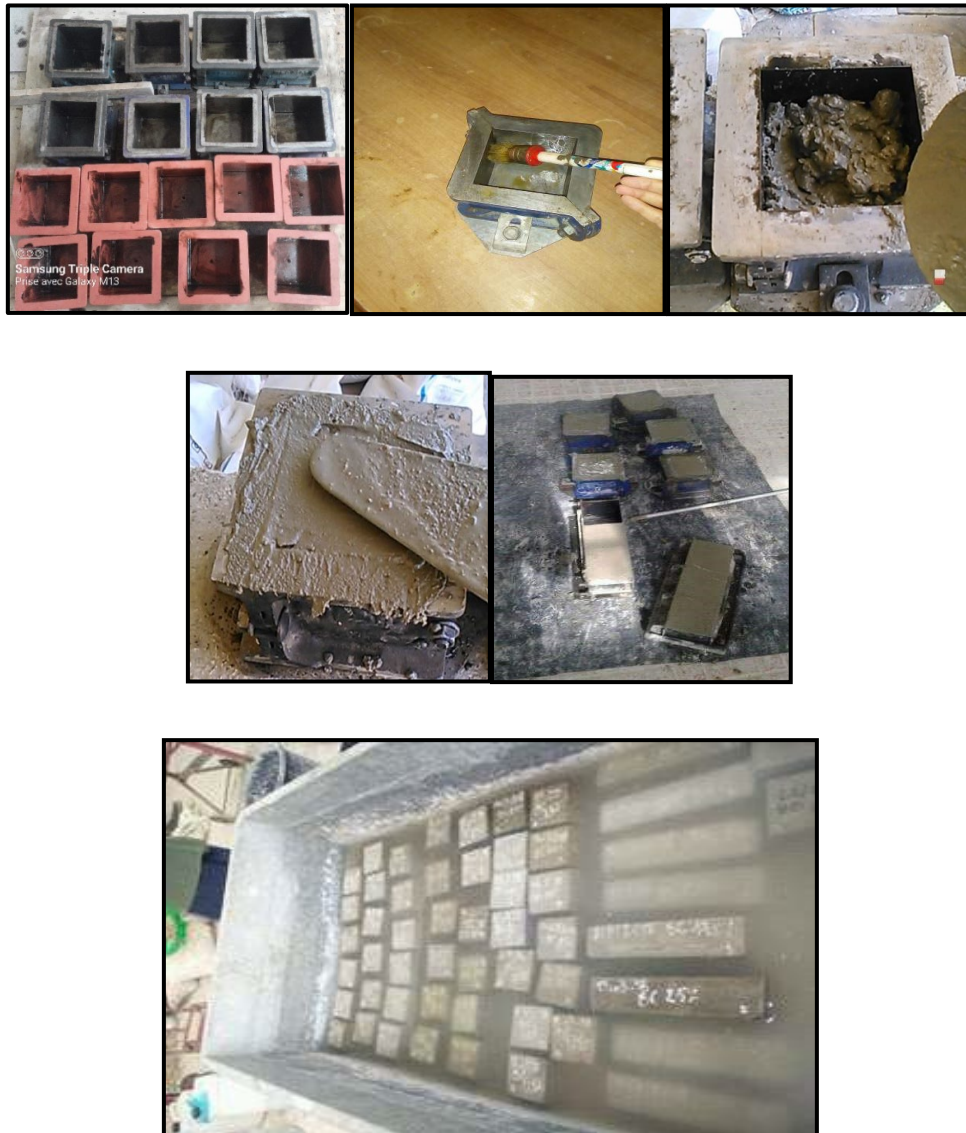
Figure II.12. Mise en place du béton et la conservation des éprouvettes
