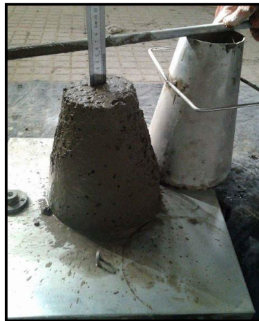
Figure III.2. Essai de l'affaissement pour le béton fibré ou ordinaire.
