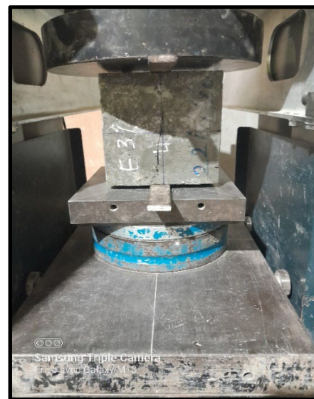
Figure III.16. Mode de rupture à traction par fendage du 4 pourcentage.
