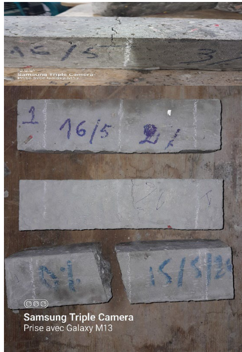
Figure III.17. Mode de rupture à la traction par flexion du 4 pourcentage.
