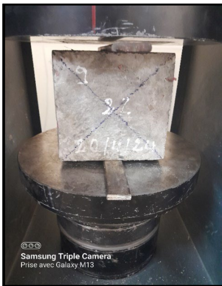
Figure III.16. Mode de rupture à traction par fendage du 4 pourcentage.
