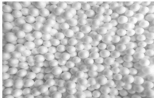
**Photo I.11** : Les billes de polystyrène expansée
