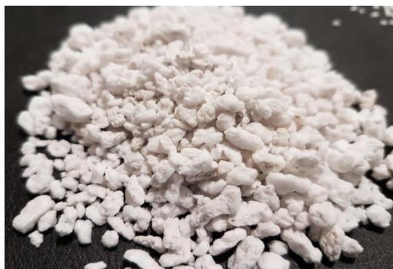
**Photo I.13** : Perlite expansée (artificielle)
