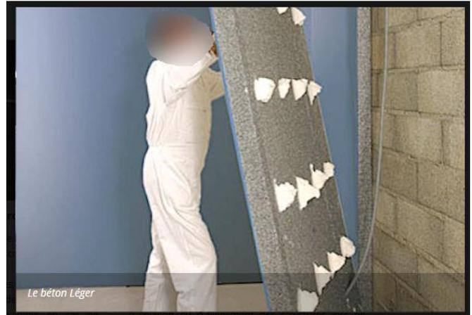
Panneau de mur en béton de vermiculite
