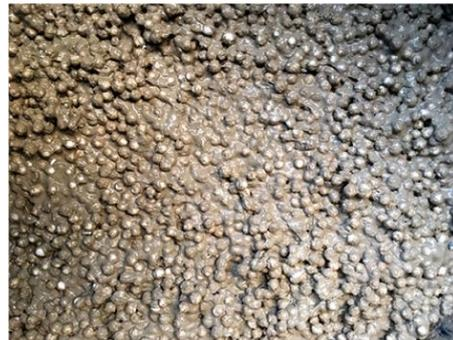
**Photo II.2** : Béton de polystyrène
