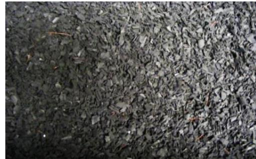
**Photo I.5** : Granulats recyclés
