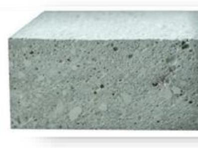
**Photo II. 2** : béton de perlite
