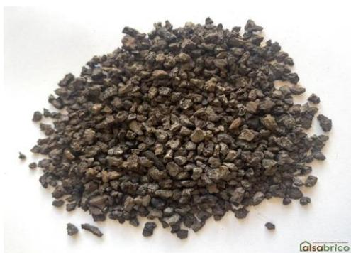
**Photo I.21** : Granulats Liège expansé
