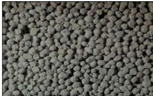
**Photo I.4** : Granulats artificiels
