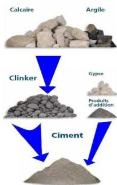
Figure III. 6 Du calcaire argileux au ciment
