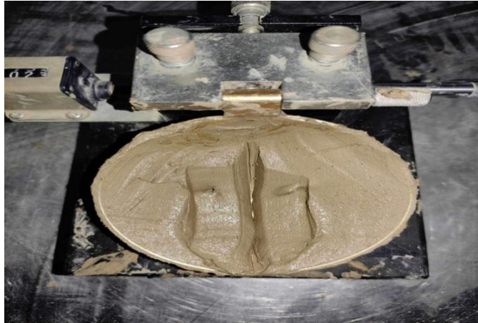
Figure IV. 19 Sol se referme sur une longueur de 12 à 13 mm après être tombé 25 fois. Le tableau IV.3 résume l'ensemble des résultats obtenus à par l'essai de l'appareil de Casagrande.
