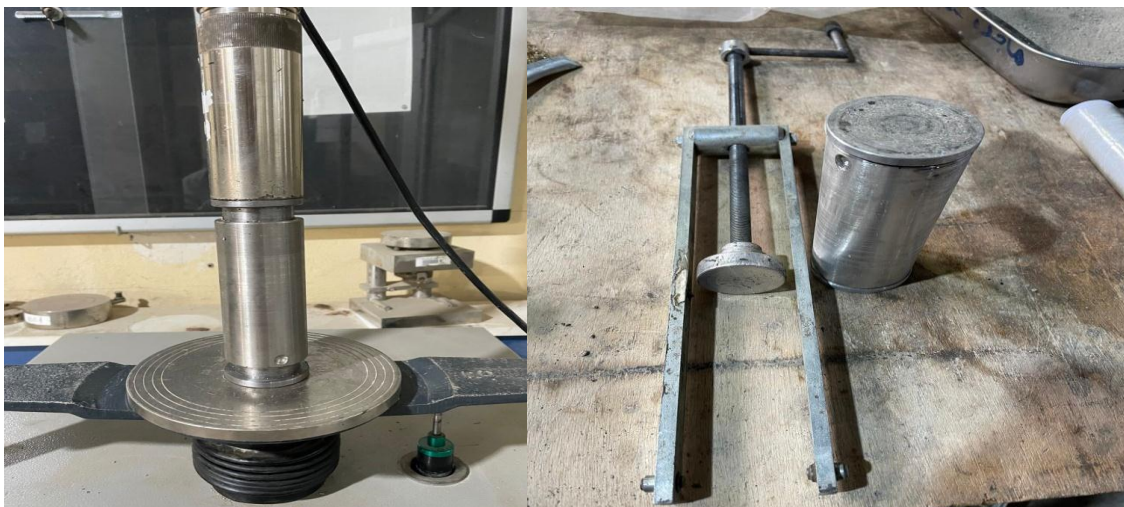
Figure IV. 31 L'équipement de l'essai de compression
