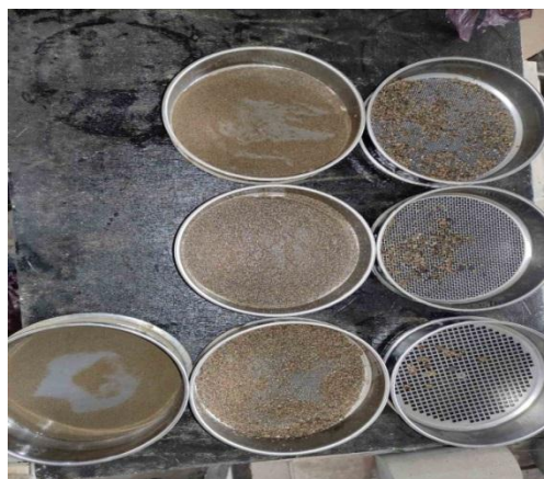
Figure IV. 10 Tamisage du sol étudié
