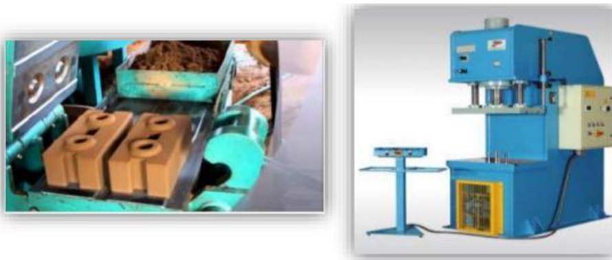
Figure II. 9 Une presse manuelle et Hydraulique.
