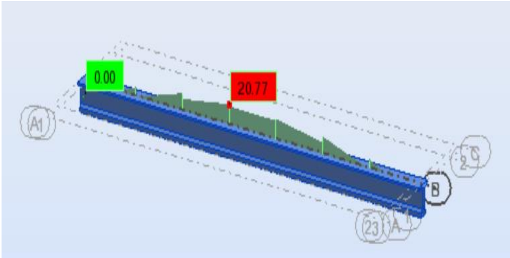
Figure IV.17: Représentation du diagramme de \sigma_f dans une section à l'ELU.
