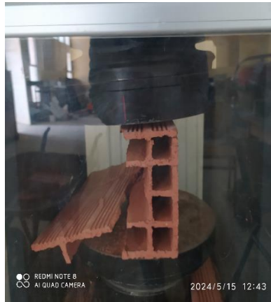
Figure III.6 : Mode de rupture de la brique en compression
