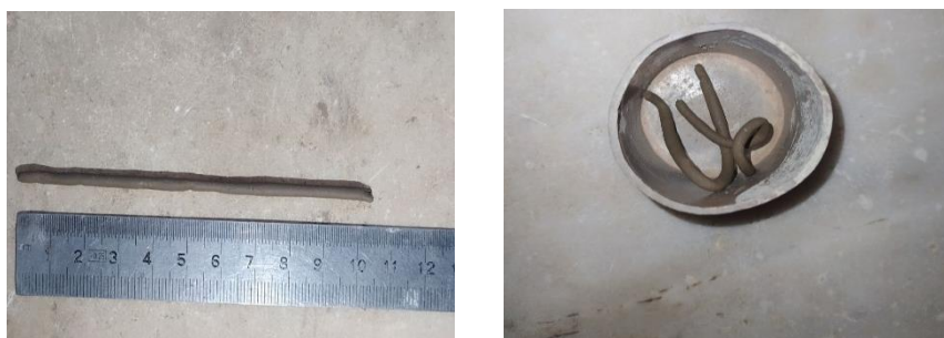
Figure II.4: Photos de détermination de la limite de plasticité.
