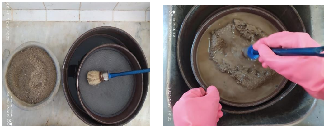
Figure II.2 : Photos de préparation des limites d'Atterberg.
