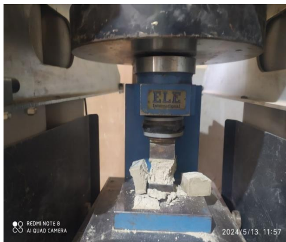
Figure III.14 : Mode de rupture des éprouvettes par la presse.
