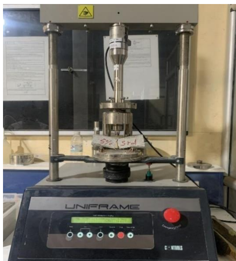
Figure II.28 : Appareil pour essai de traction par flexion.
