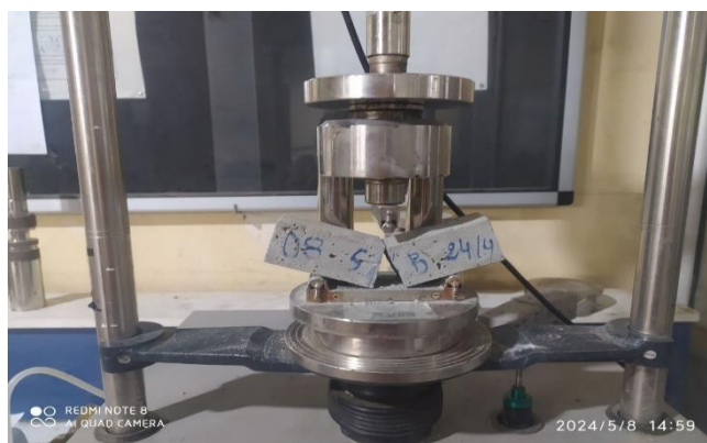
Figure III.10 : Mode de rupture du mortier en flexion 3 points
