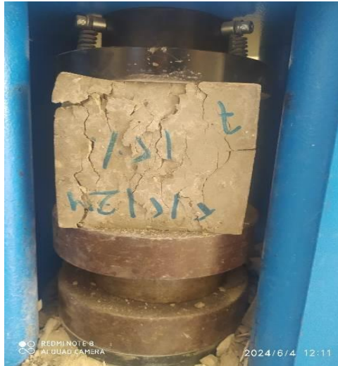
Figure III.8 : Mode de rupture des éprouvettes par la presse
