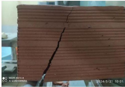
Figure III.4 : Mode de rupture de la brique en flexion 3 points
