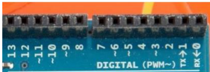
Figure II.6 : Broches numériques de la carte Arduino UNO [10].
