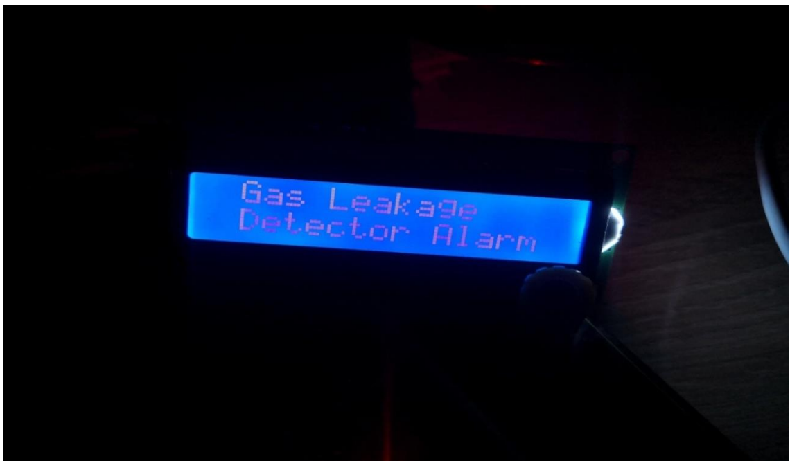
Figure III.12: Affichage du message « Gas Leakage, Detector Alarm ».
