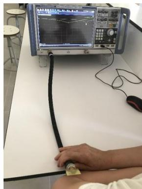
**Figure III.11:**Analyseur de réseau R&S®ZNB20.
