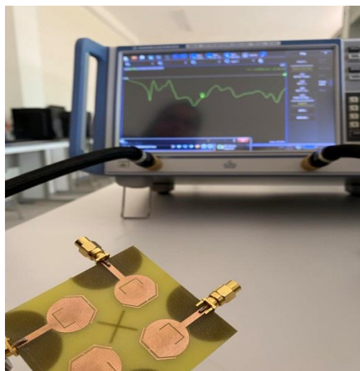
Figure III.37 : Mesure des paramètres de l'antenne MIMO réalisée par le VNA
