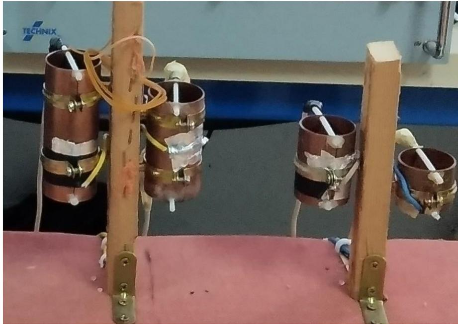
Figure II.6 : L'électrode active de type coaxial
