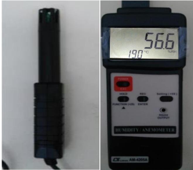
Figure II.5 : photographie de l'hygromètre numérique
