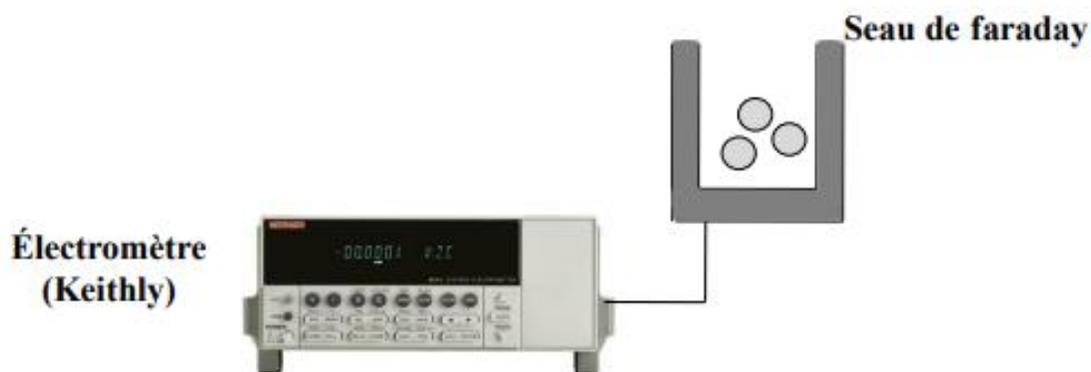
Figure II.2 : Système de mesure de la charge électrique
