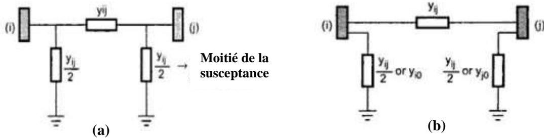
Figure II.1 Schéma équivalent en  $\pi$  des lignes [1]
