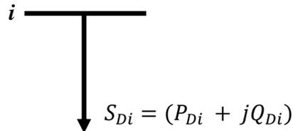
**Figure I.2 :** Modèle d'une charge
