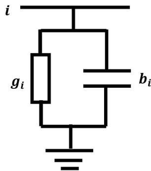
Figure I.3 : Modèle d'élément shunt
