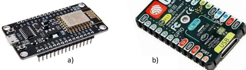
Figure II. 7. a) Node MCU ESP8266/32. b) ESP32-C3 RISC-V.
