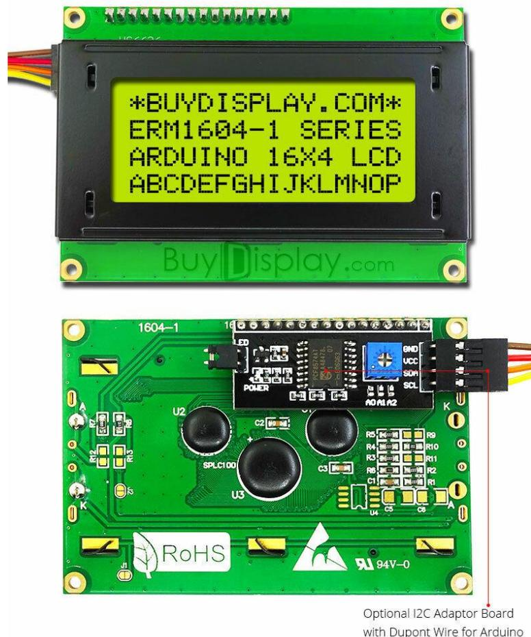
Figure II. 17. Ecran LCD 16x4 avec I2C module.
