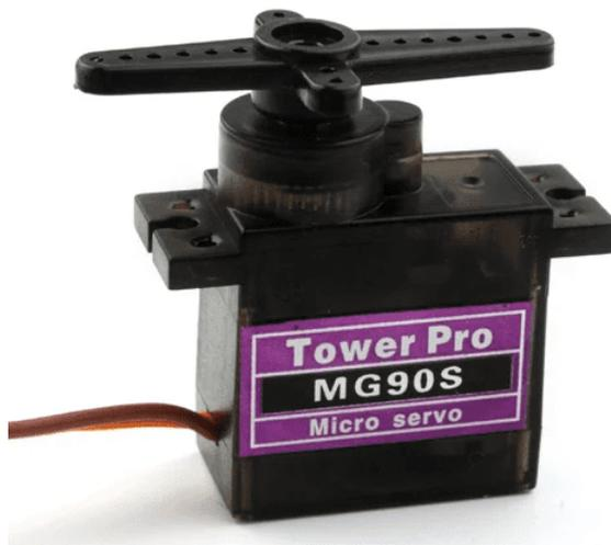
Figure II. 19. Servo moteur MG90S.
