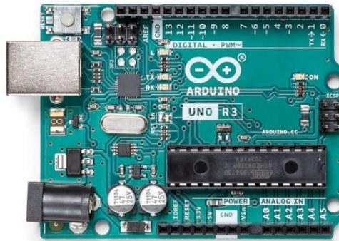
Figure II. 6. Arduino UNO.
