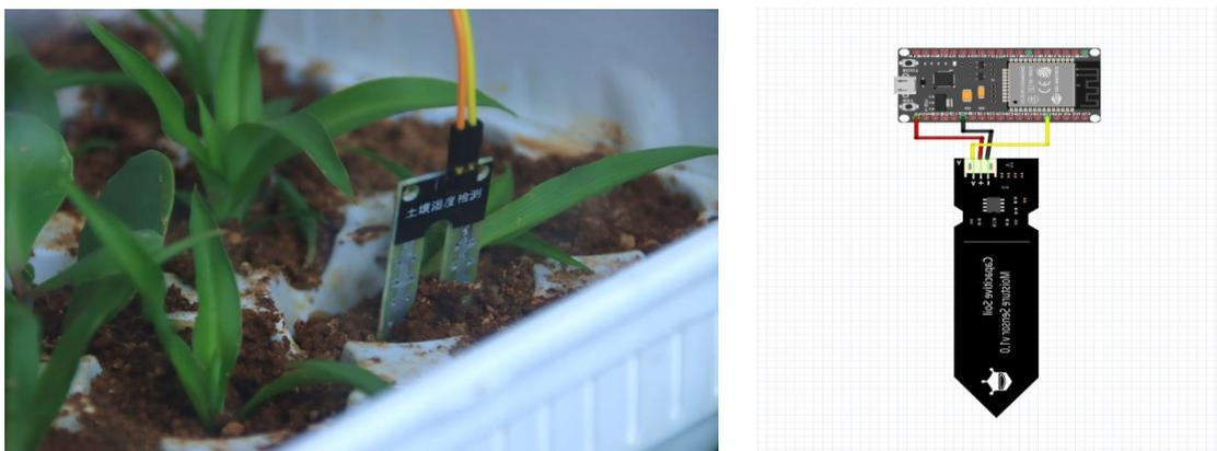
Figure III. 11. Emplacement et montage électrique du capteur d'humidité de sol.
