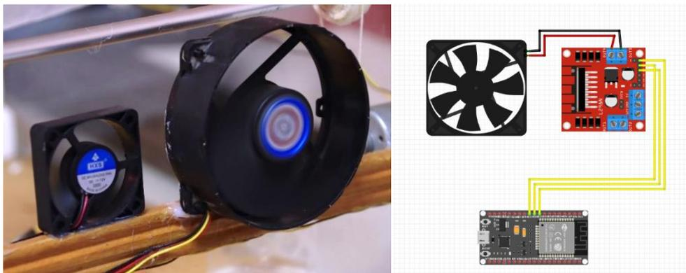
Figure III. 16. Emplacement et montage électrique des ventilateurs.
