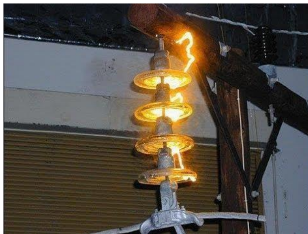
Figure III.1 : Phénomène de contournement dans un isolateur [34].
