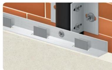
Fixation au moyen de profilés sur le carreau rainuré
