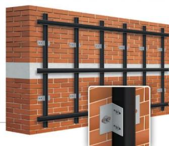
Figure 29 : schémas représentant des profils de la fixation de la façade ventilée
