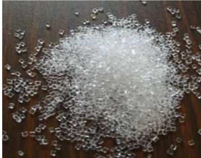
**Figure II.2.** Granulé du PMMA.
