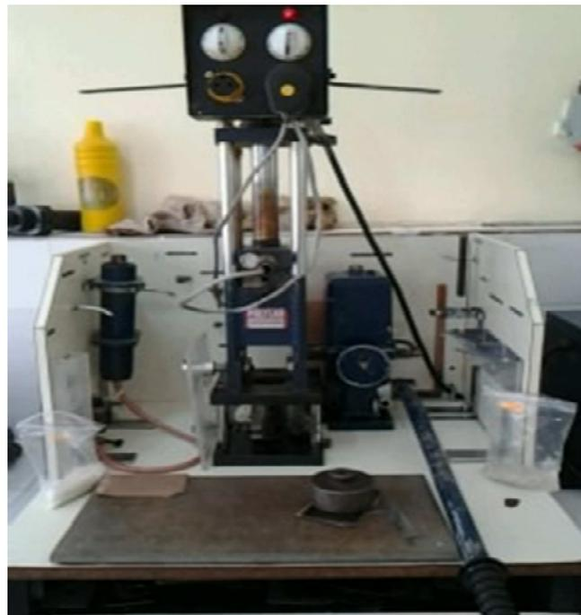
**Figure II.6.** Presse manuelle de type POLYLAB, université de Sétif.
