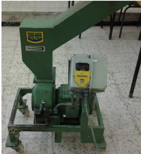
**Figure II.5.** Broyeur de type Brabender université de Sétif.
