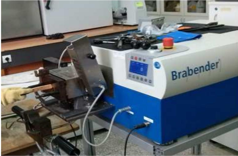
**Figure II.4.** Plastographe de type Brabender, Université de Sétif.
