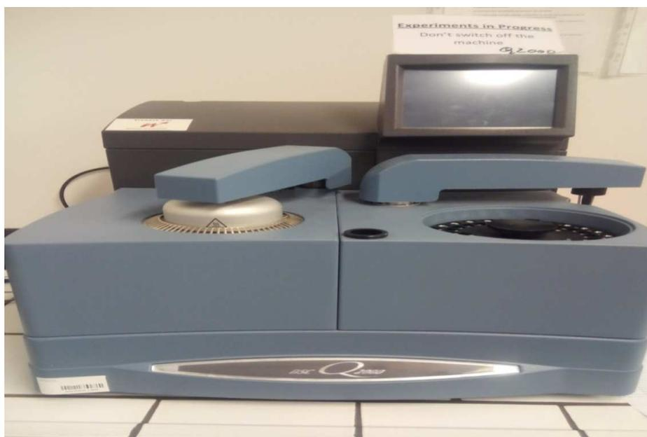
**Figure II.11.** DSC Q2000 de type TA instrument Université de Mons.
