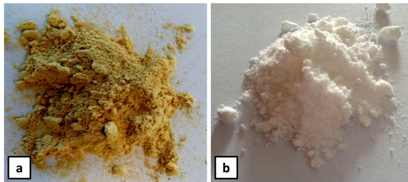
Figure IV-9: Poudre d'extraits insolubles des graines de Cc: (a); Avant traitement de blanchiment, (b); Après le traitement de blanchiment.
